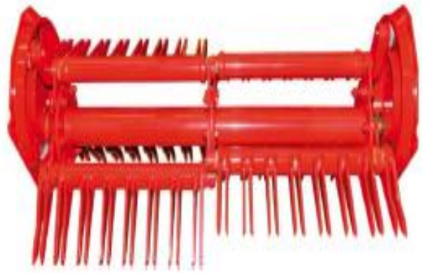
Рис. 3. Вигляд подавального пристрою Supermatic візків-підбирачів Boss junior і Boss LT
