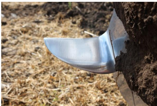
Рис. 1. Типова поверхня тертя РО ГМ (робочий орган фірми Vednar FMT, напрацювання агрегату 130 га, Попільнянський район, Житомирської області).
