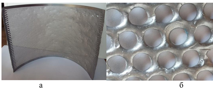
Рис. 4. Зношене експериментальне решето: а – загальний вигляд; б – фрагмент зношеної поверхні.
