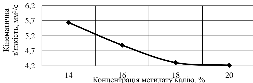
Рис. 1. Залежність кінематичної в'язкості дизельного біопалива виробленого із олії отриманої із зернового ворохувід концентрації метилату калію
