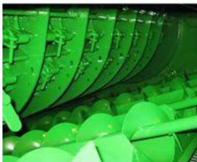
Рис. 2. Підбарабання з вкладишами.
