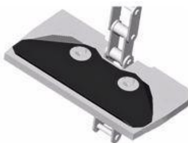
Рис. 5. Лопатки зернового елеватора з сталевою пластиною.
