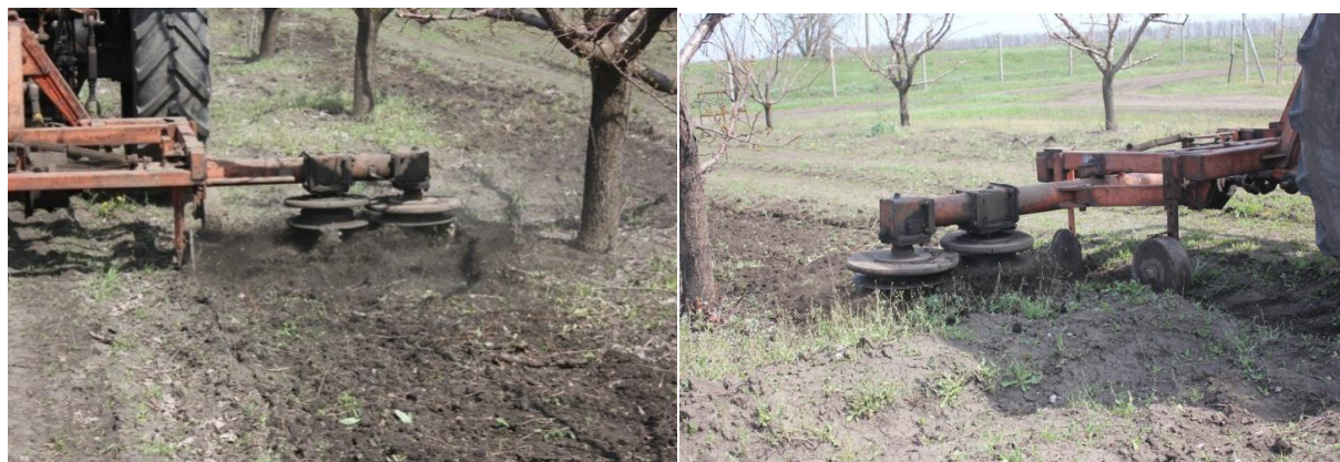
Рис. 3. Обробіток ґрунту в пристовбурній смузі фрезерною машиною МФ-1М з експериментальними робочими органами
