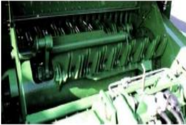
Рис. 2. Схема подрібнювального пристрою з керованими граблинами візків-підбирачів Titan
