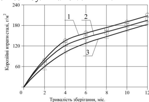
Рис. 2. Динаміка корозійних втрат зразків сталей розмішених на поверхні ґрунту в умовах відкритої атмосфери: 1 – сталь Ст3; 2 – сталь 45; 3 – сталь 65Г
