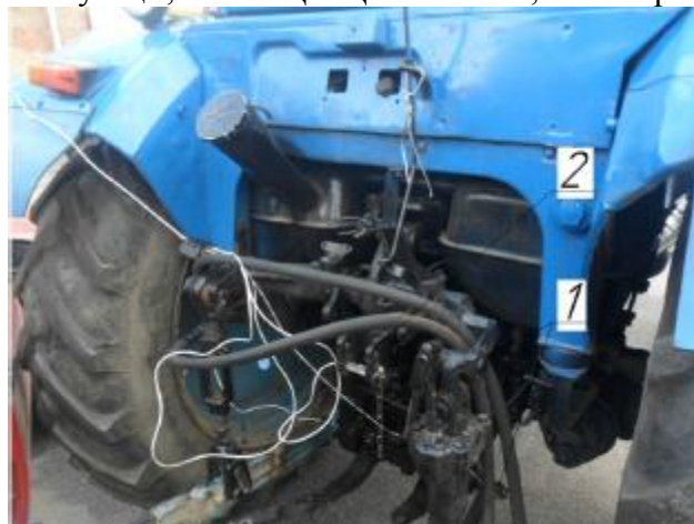
Рис. 2. Встановлення тензодатчиків для вимірювання зусиль:
