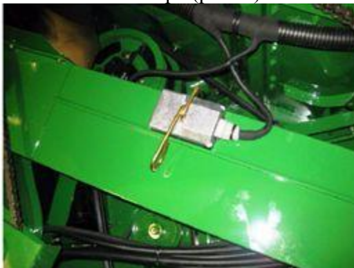
Рис. 4. Лазерний датчик на корпусі елеватора.
