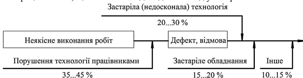
Рис. 2. Причинно-наслідкова діаграма якісного виконання сервісних робіт
