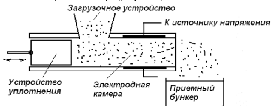
Рис. 1. Схема установки электрогидротермической обработки фуражного зерна
