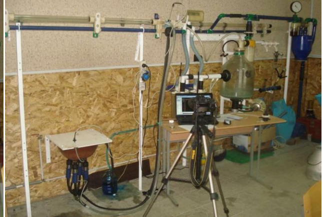
Рис. 2. Загальний вид експериментального стенду доїльної установки із доїльним апаратом попарної дії при підключенні його до верхнього молокопроводу
