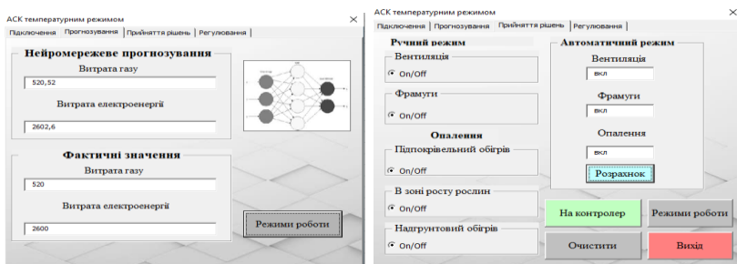
Рис. 1. – Інтерфейс інтелектуальної системи енергоефективного керування параметрами мікроклімату
