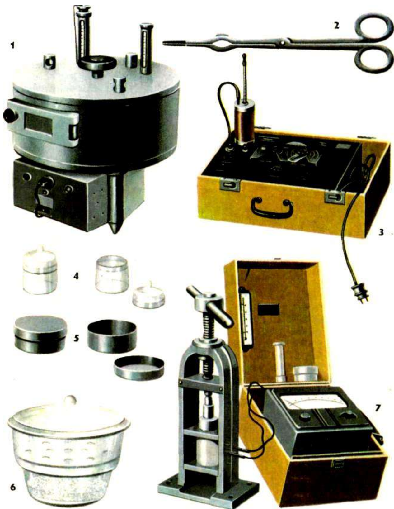
Рис. 70. Прилади та інвентар для визначення вологості насіння: 1 – сушильна шафа СЭШ-3, 2 – тигельні щипці, 3 – електровологомір «гигрорекод» Ф-8, 4 – бюкси скляні, 5 – бюкси металеві, 6 – ексикатор з хлористим кальцієм, 7 – електровологомір ВЭ-2М [39].
