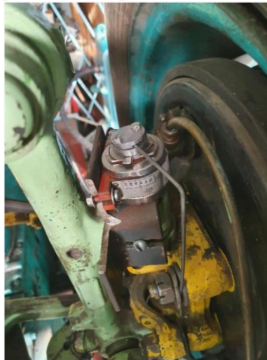
Рисунок 2 – . Кріплення датчика кута повороту керованих коліс
