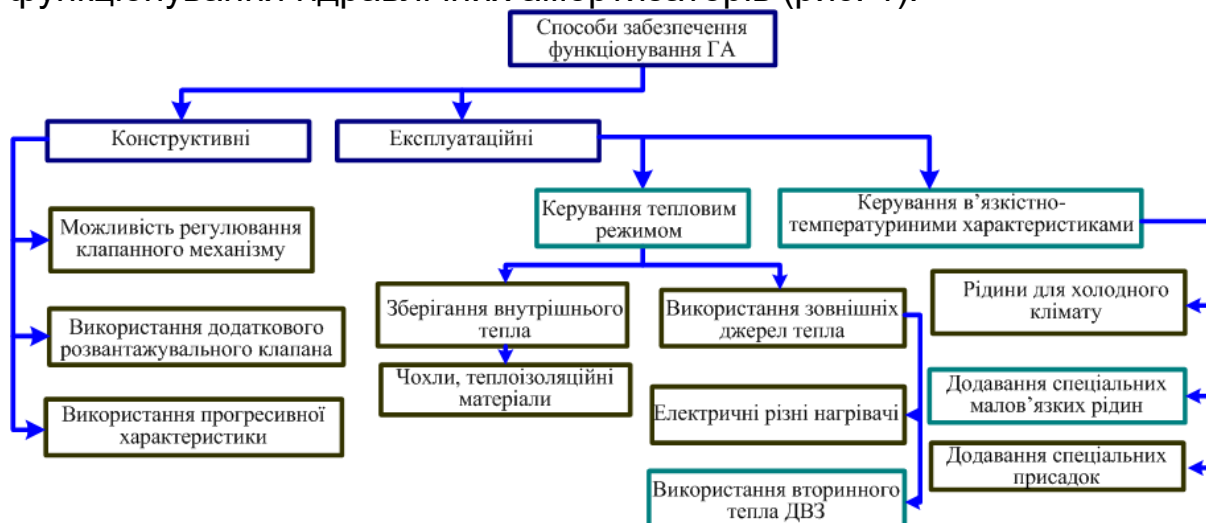
Рис. 1. Способи забезпечення функціонування гідравлічних амортизаторів автомобіля
