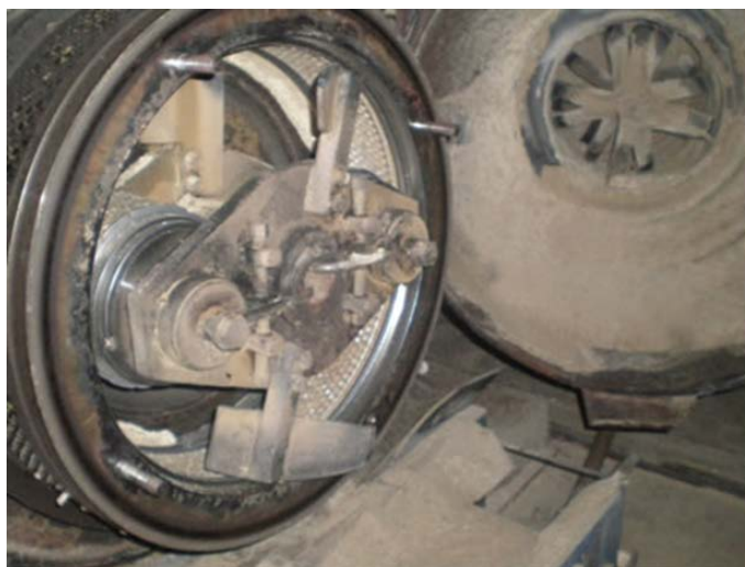
Рис. 1. Проведення щозмінного технічного огляду пресового вузла гранулятора
