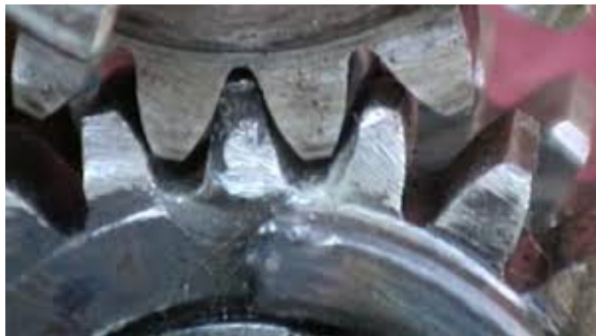
Рис. 1. Руйнування зубів коліс високо-напруженої зубчастої передачі
