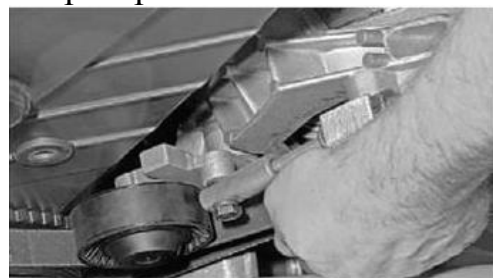
Рис. 2. Органолептичний метод контролю натягу ременя генератора
