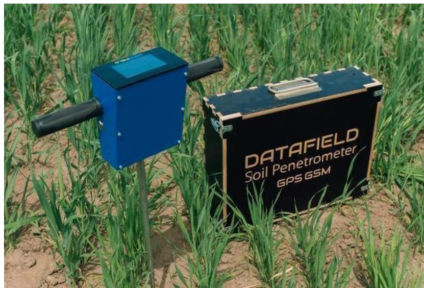
Рис. 2 – Ручний пенетрометр з електронним циферблатом та GPS
