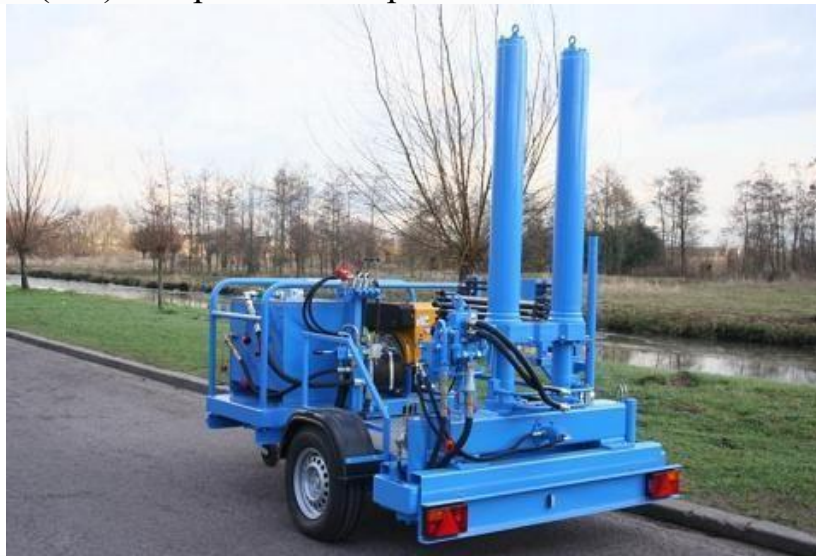
Рис. 3 - Гідравлічний пенетрометр GeoMil 200kN (20т)
