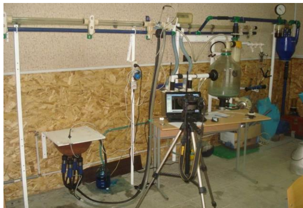
Рис. 2. Загальний вид експериментального стенду доїльної установки із доїльним апаратом попарної дії доїльної установки із доїльним апаратом попарної дії при підключенні його до верхнього молокопроводу
