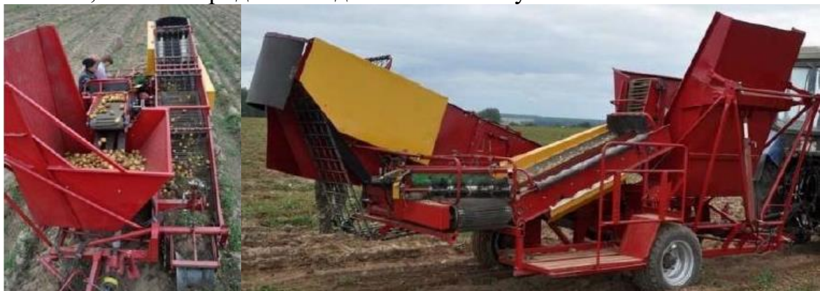
Рис. 2. Однорядний картоплезбиральний комбайн ККУ-1
