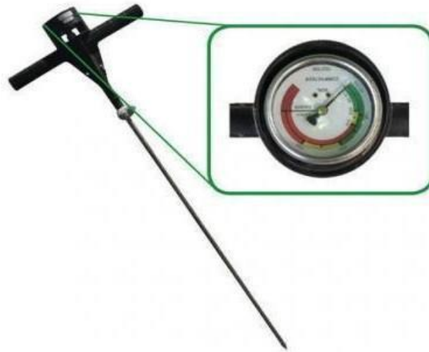
Рис. 1 – Загальний вигляд ручного пенетрометра з механічною шкалою
