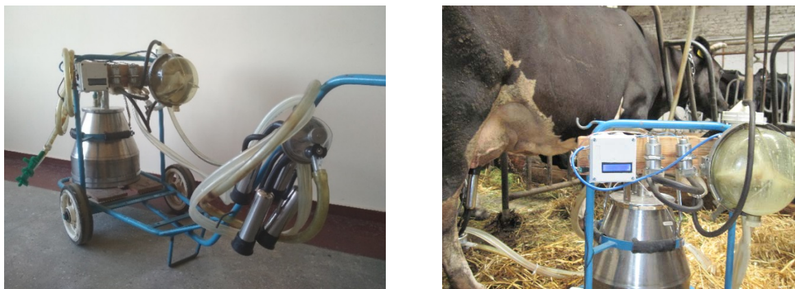
Рисунок 1 – Загальний вигляд доїльного апарата з експериментальним блоком керування для адаптивної зміни режиму роботи
