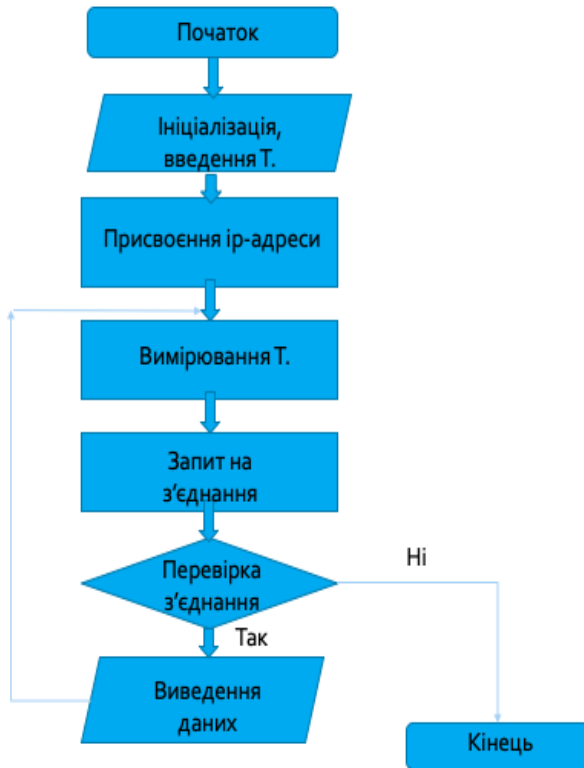
Рис. 1. Загальний алгоритм роботи дистанційного вимірювання температури (T).
