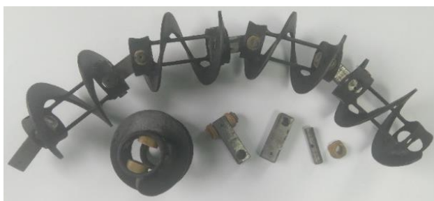
Рисунок 1 – Конструктивна та розрахункова схема шнека, в якого секції є шарнірно з'єднаними між собою: а – схема двох секцій; б – загальний вигляд секцій шнекового органу, розміщеного на криволійній ділянці та його окремих елементів
