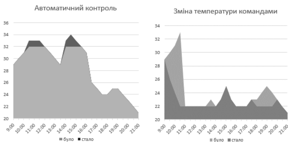
Рисунок 2 – Результати тестування IoT-бота: а) робота чат-бота в автономному режимі; б) керування температурою згідно команд користувача
