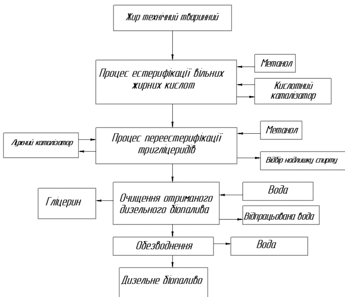
Рис. 1. Технологічна схема виробництва дизельного біопалива [1-3]
