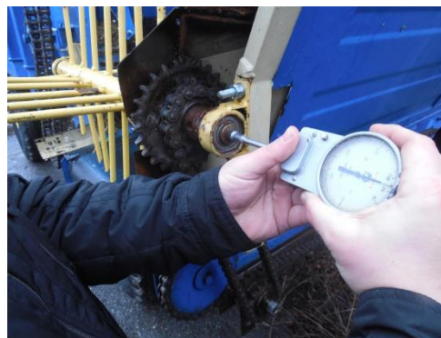
Рисунок 2 - Визначення частоти обертання валу робочого органа на валу відбору потужності
