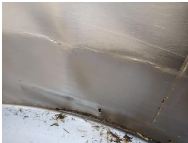
Рисунок 1 – Спрацювання бокової (вертикальної) стінки бункера
