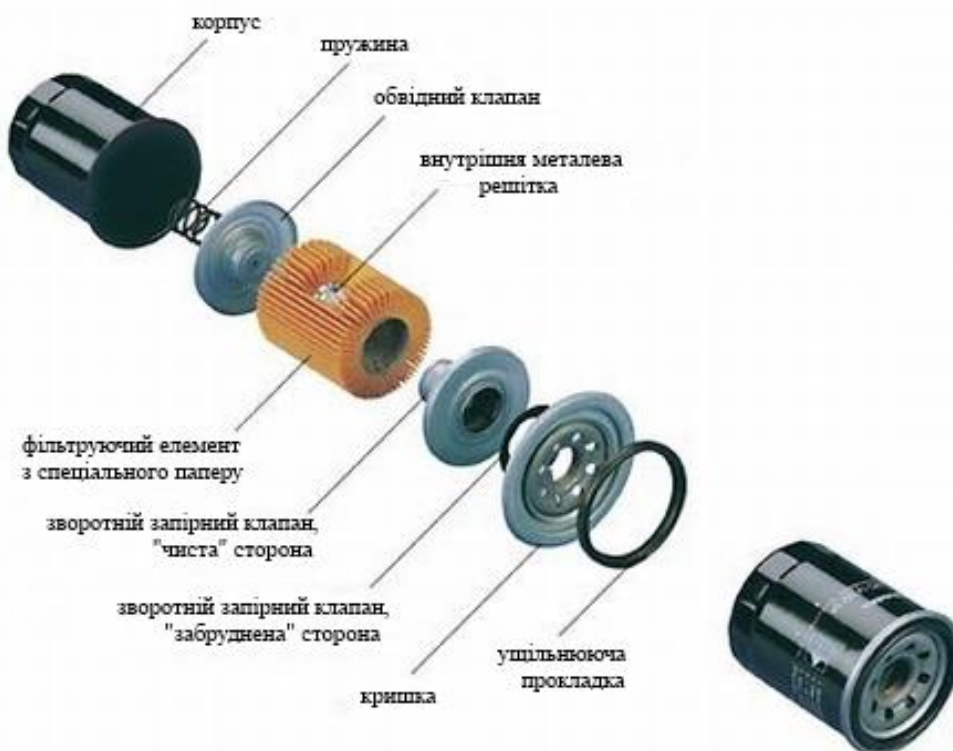
Рис. 1. Будова фільтра для очищення оливи ДВЗ WL 7323
