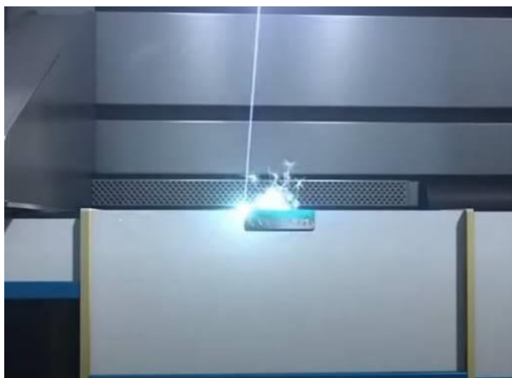
Рис. 1. Спікання лазером шару металевого порошку
