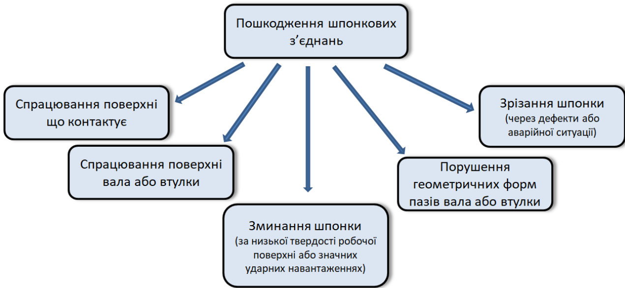
Рис. 2 Характерні види пошкоджень шпонкових з'єднань
