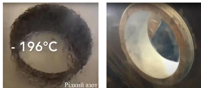
Рис. 1. Встановлення сталеві втулки в корпус із застосуванням глибокого холоду (кріогенний метод)
