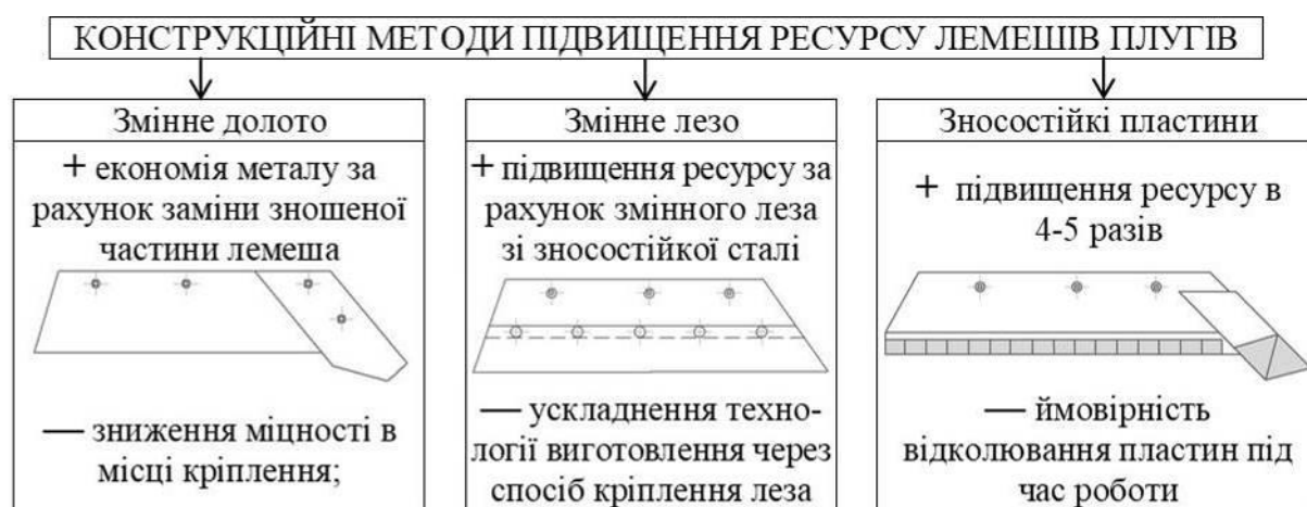
Рис. Конструкційні методи підвищення ресурсу лемешів плугів
