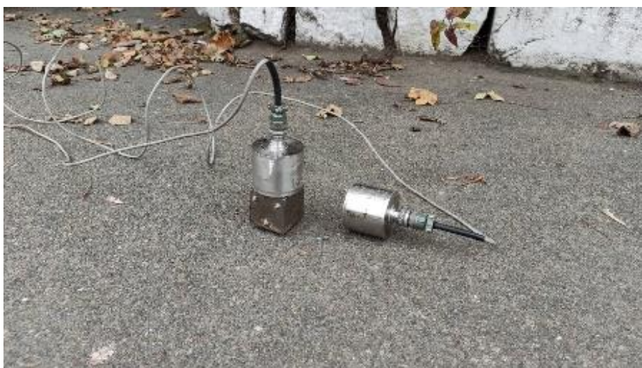
Рис. 2. Розміщення датчиків вібрації на ґрунті
