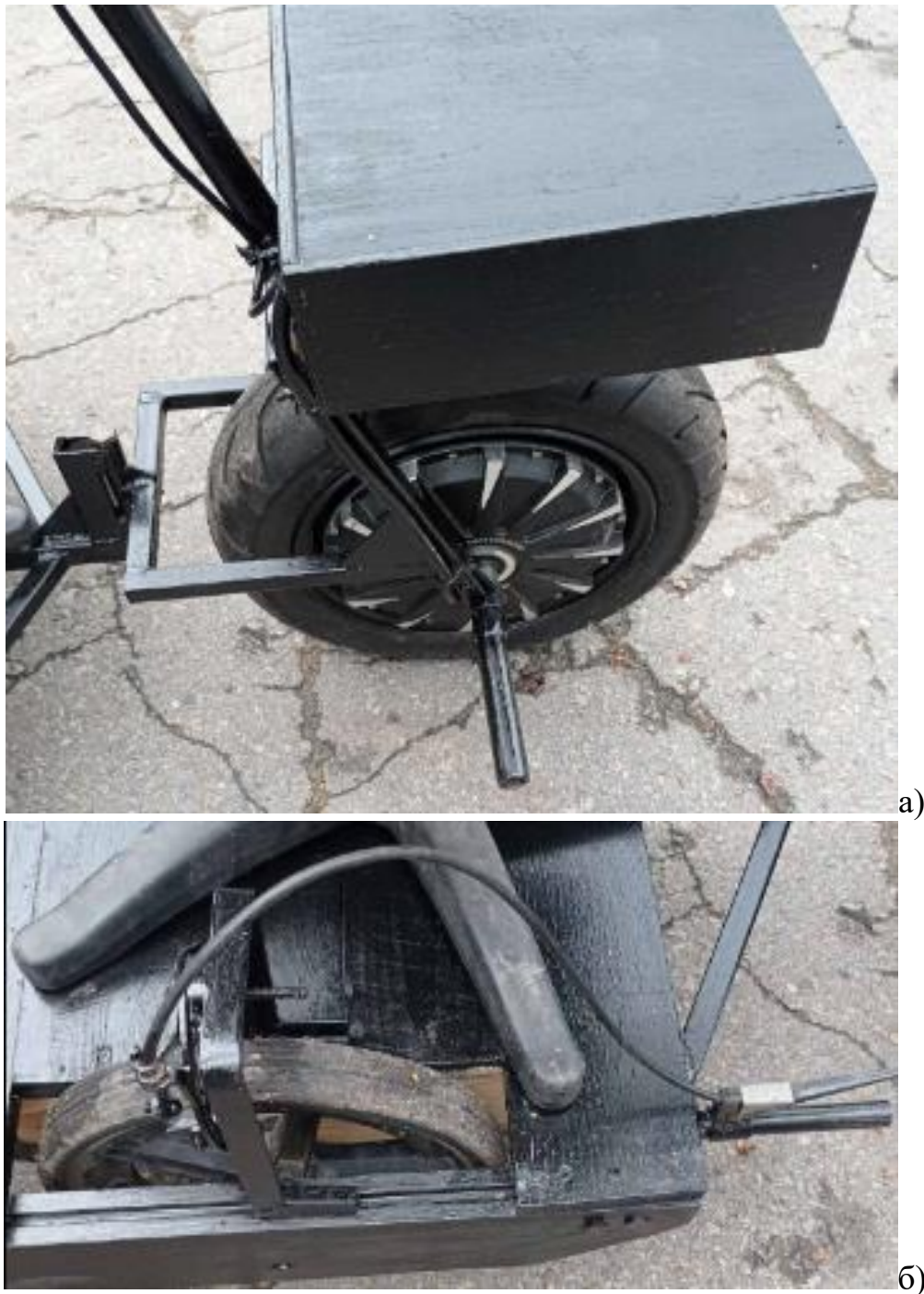
Рис. 2. Елементи конструкції АіТС-2: а) модуль А – рама, мотор-колесо, бокс для тягової батареї, підніжки, причіпний пристрій; б) елементи гальмівної системи, змонтовані на модулі Б.
