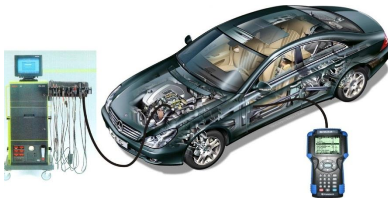
Рис. 1. Обладнання для діагностування електронної системи керування двигуном автомобіля.
