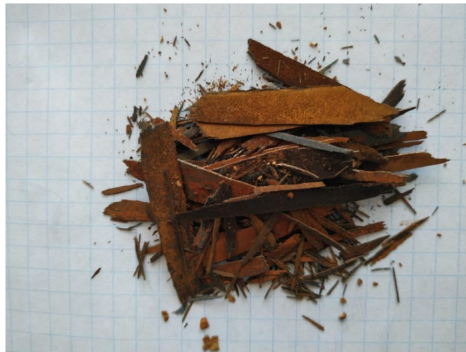
Рисунок 1. Фрагменти накипу, утвореного на стінках водонагрівача в одній із садиб с. Витвиці
