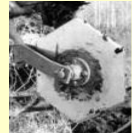
Рис. 4. Експериментальні зразки робочих органів а - сферичний диск; б - двосекційний лущильник із експериментальними робочими органами; в - дисковий ніж.
