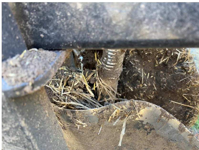
Рис. 5. Забивання між лапою та закриваючим диском агрегату Kuhn Krause Gladiator
