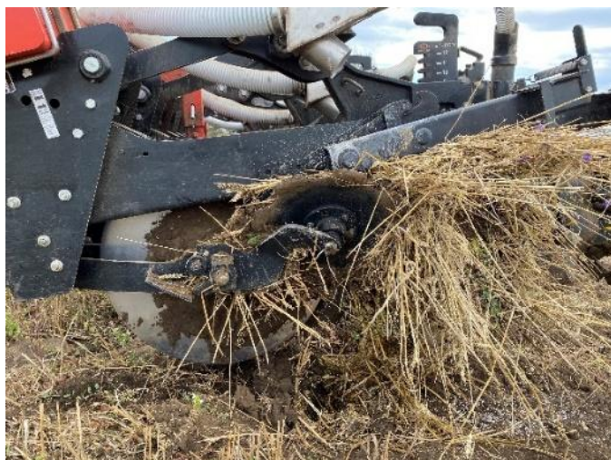
Рис. 3. Забивання перед лапою агрегату Kuhn Krause Gladiator
