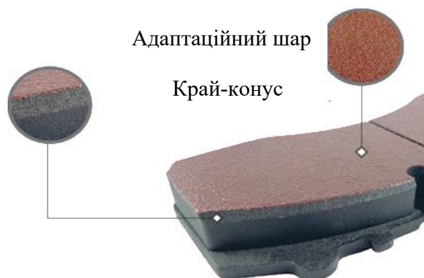
Рис. 2. Зразок удосконаленої гальмівної колодки 2TP-114 Tr108 R3
