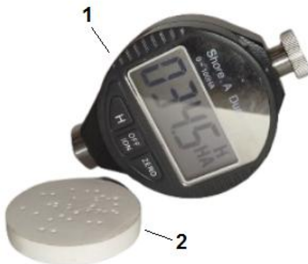
Рис. 1. Прилад і зовнішній вигляд дослідженого зразка: 1 – твердомір Шора моделі 5610 зі шкалою А; 2 – зразок пористого ПТФЕ після вимірювань.
