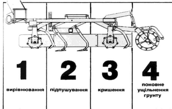
Рис. 1. Технологічна схема комбінованої ґрунтообробної машини “КОМПАКТОР” фірми “LEMKEN”
