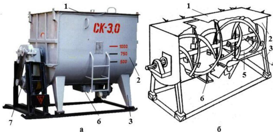
Рис. 1. Горизонтальний змішувач кормів СК-3,0: а – загальний вигляд; б – конструктивна схема, 1 – кришка; 2 – корпус зі змішувальною камерою; 3 – рама; 4 – вал зі стрічковою навивкою (шнек); 5 – лопаті вала; 6 – вивантажувальне вікно; 7 – електропривод.
