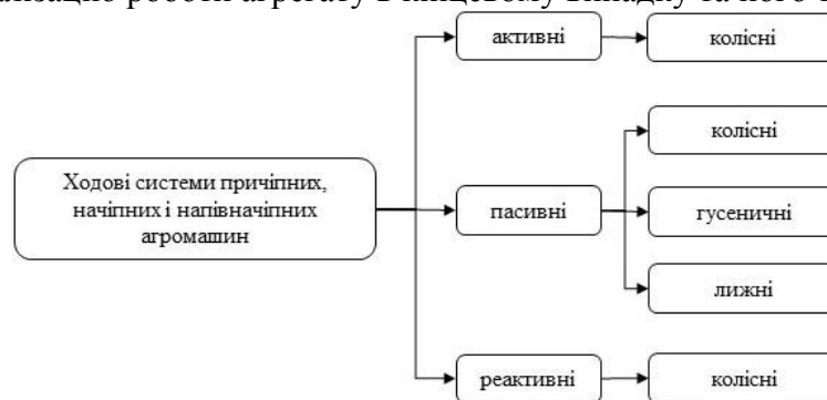
Рис. 2. Фрагмент класифікації ходових систем причіпних, начіпних і напівначіпних агромашин
