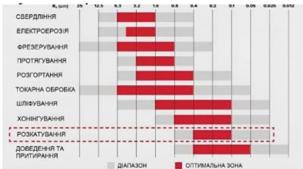
Рис. 3. Порівняння рівня шорсткості по методу обробки
