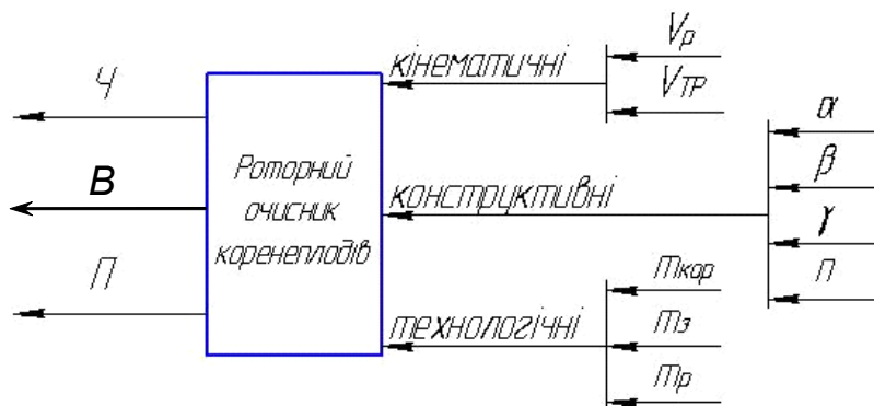
Рис. 1. Модель роторного очисника коренезбиральної машини.
