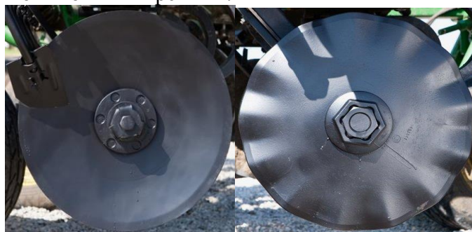
Рис. 3. Конфігурація лез дисків різних секцій машини
