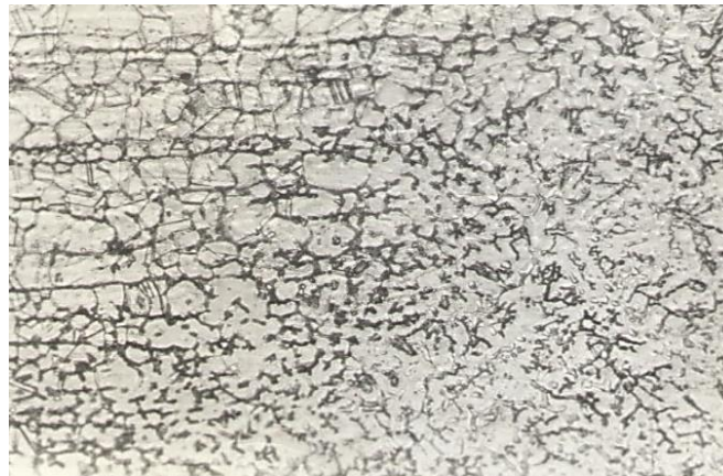
Рисунок 3. Мікроструктура точкового покриття x 250
