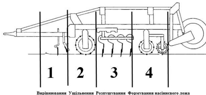
Рис. 2. Технологічна схема комбінованої ґрунтообробної машини “ОПТИМАТОР” („KONGSKILDE”)
