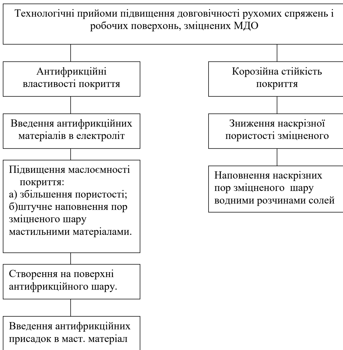
Рис. 1. Можливі технологічні прийоми підвищення довговічності рухомих спряжень і робочих поверхонь деталей машин, зміцнених МДО.
