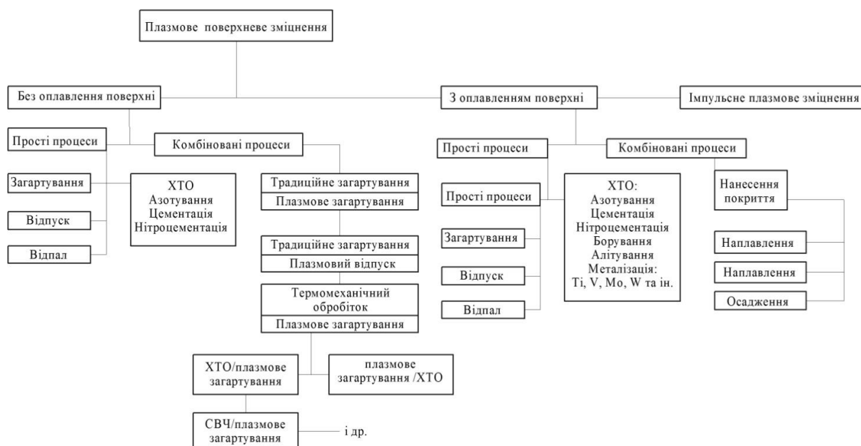
Рис. 1. Способи плазмового поверхневого зміцнення матеріалів.
