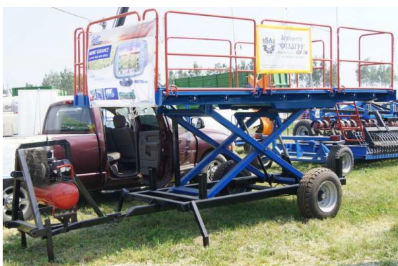
Рис. 3. Загальний вигляд причіпної садової платформи ППСК.
