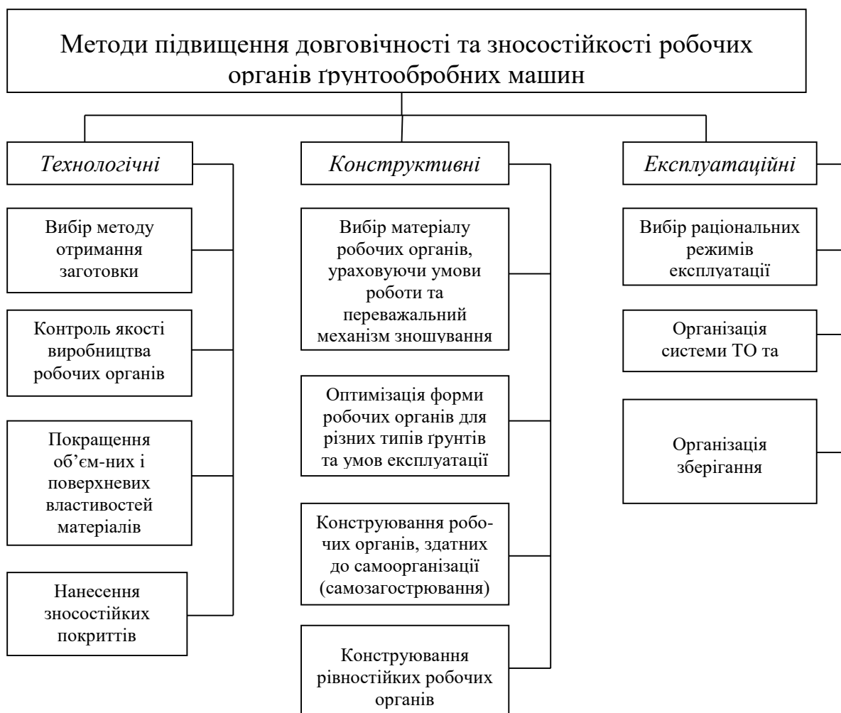
Рис. 1. Методи підвищення довговічності та зносостійкості робочих органів ґрунтообробних машин
