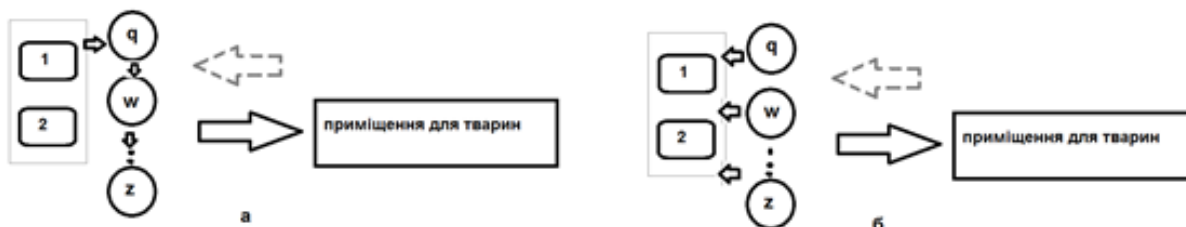
Рис. 1 – Блок-схеми технологічних ліній з приготування та роздавання кормосуміші на тваринницькій фермі: а – переміщення мобільного кормороздавача (1) та завантажувача (2) між майданчика для різних компонентів ( q , w , z ); б - підвезення кормів з різних майданчиків ( q , w , z ) транспортними засобами до кормового майданчика з завантаженням їх завантажувачем (2) у мобільний кормороздавача «міксер» (1).
