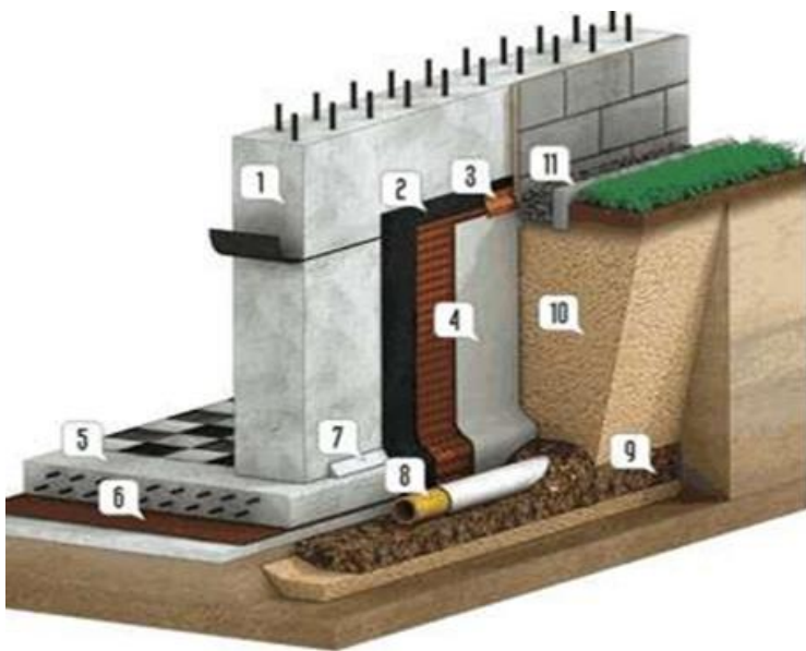
Рис. 4. Конструктивна схема організації пристінного дренажу
