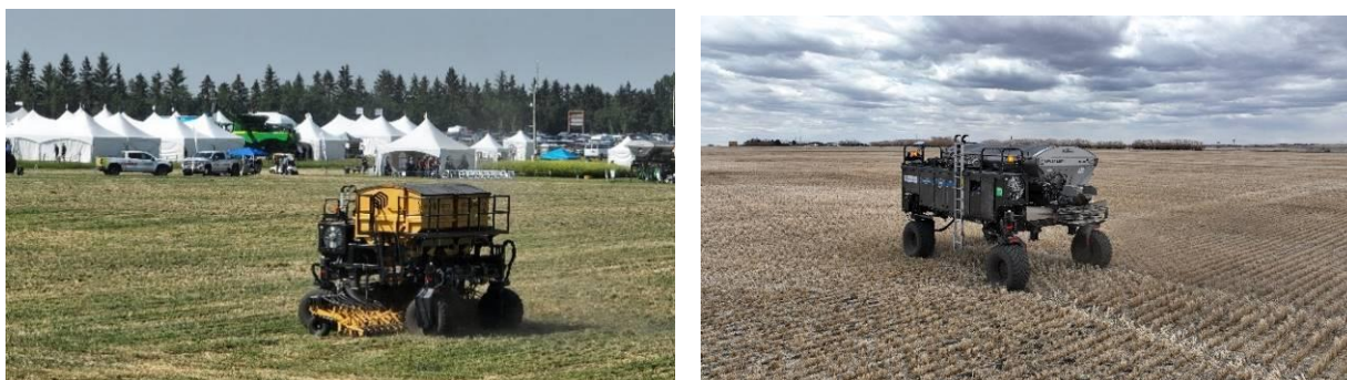
Рис. 1. Автономні платформи DOT а) та OMNI б) на виконанні відповідно, сівби зернових та внесенні мінеральних добрив.
