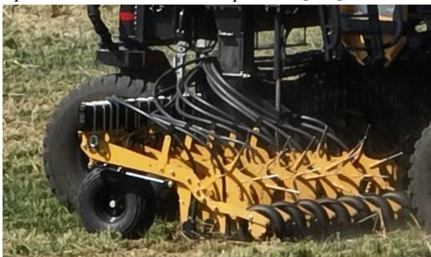
Рис. 2. Серійні виконавчі механізми зернової сівалки Seed Master в агрегаті з автономним роботом DOT.
