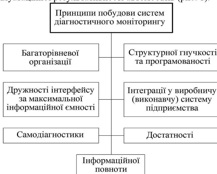
Рис. 1. Основні принципи побудови систем діагностичного моніторингу вантажних автомобілів
