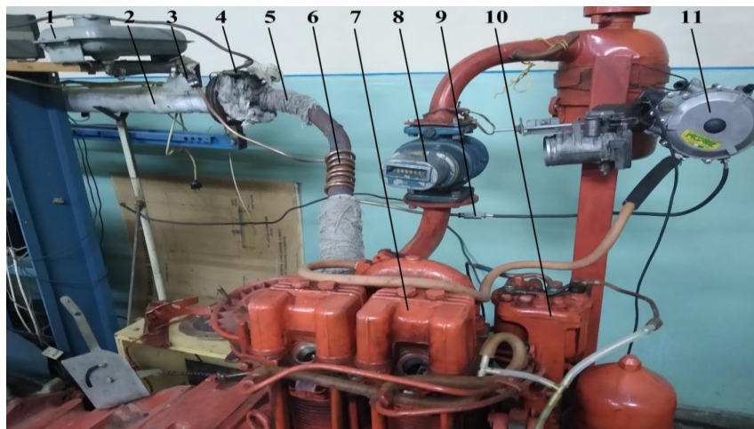
Рис. 1. Зовнішній вигляд стенду на базі дизельного двигуна Д21 з термохімічним реактором: 1 – резервуар для зрідженого метанолу; 2 – випускний колектор; 3 – метанольний фільтр; 4 – випускний колектор; 5 – теплоізоляція випускного колектора; 6 – термохімічний водневий реактор (теплоізоляція реактора частково демонтована); 7 – дизельний двигун Д21; 8 – лічильник газу; 9 – вікно в трубі подачі метанолу; 10 – ПНВТ; 11 – газовий редуктор
