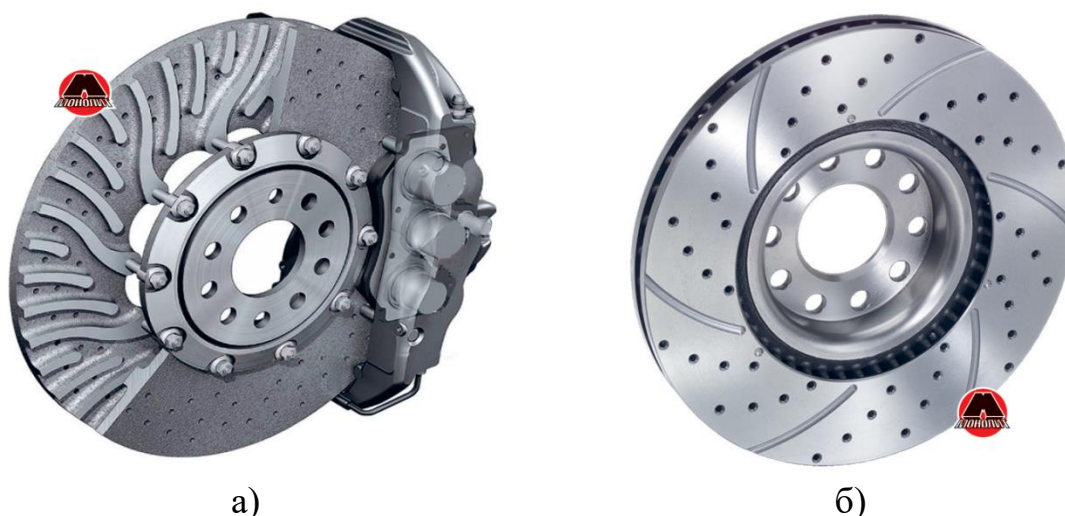
Рис. 1. Приклад вентиляваного гальмівного диска: а) без канавок; б) із спеціальними канавками.
