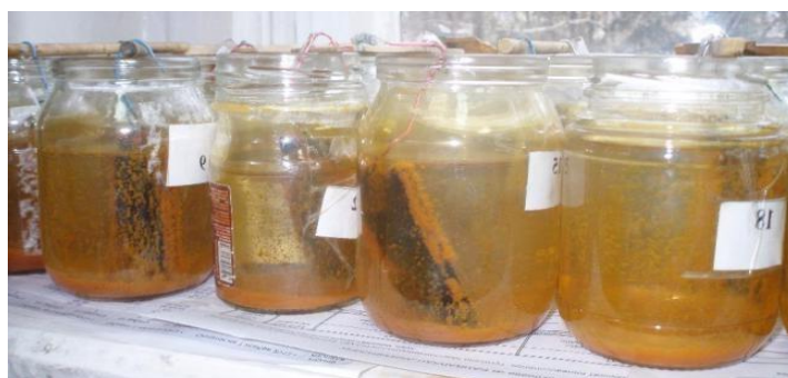
Рис. 1. Деталі з покриттями у корозійно-активних розчинах
