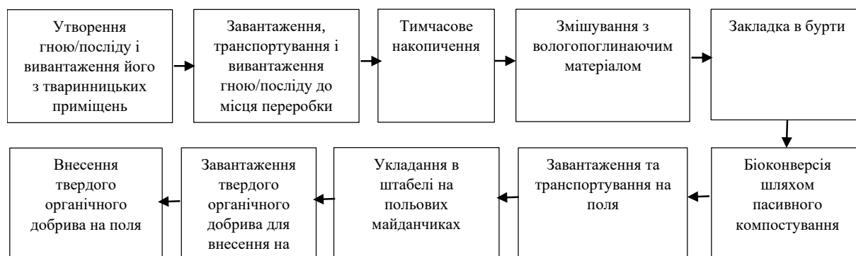
Рис. 1. Блок-схема технології біоконверсії методом пасивного компостування у буртах.
