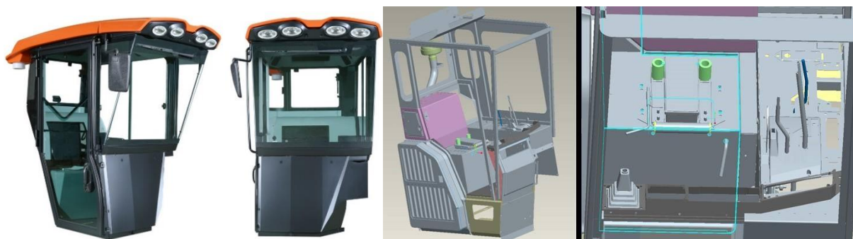
Рис. 1. 3D-модель кабіни зернозбирального комбайна (модель компанії А) для перевірки системи оцінки видимості
