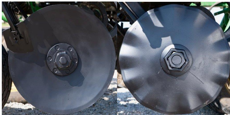
Рис. 3. Конфігурація лез дисків різних секцій машини.
