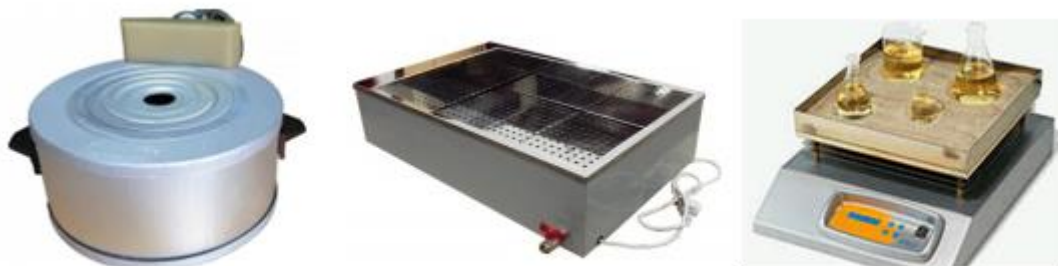
Рис. 12 – Комбінована водяна, масляна, пісочна бані з електричним нагріванням
