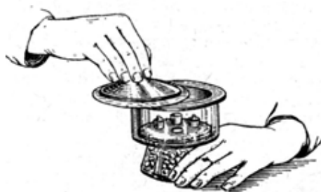
Рис. 35 - Охолодження прожарених тиглів в ексикаторі та їх зберігання без поглинання води і газів
