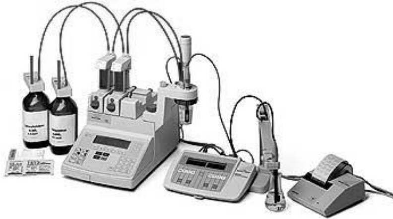
Рис. 6 - . Автоматизований комплекс для визначення величини ОВП природних вод в динамічному режимі
