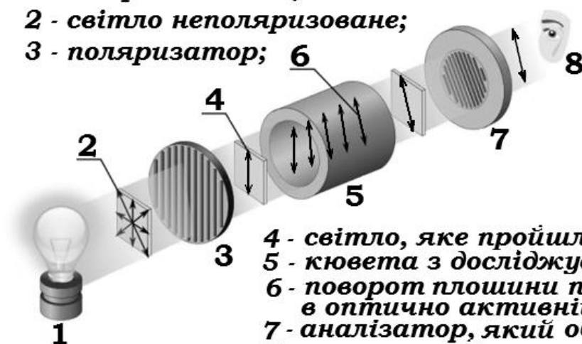
Рис. 4.14. Схема поляриметра Ніколя
