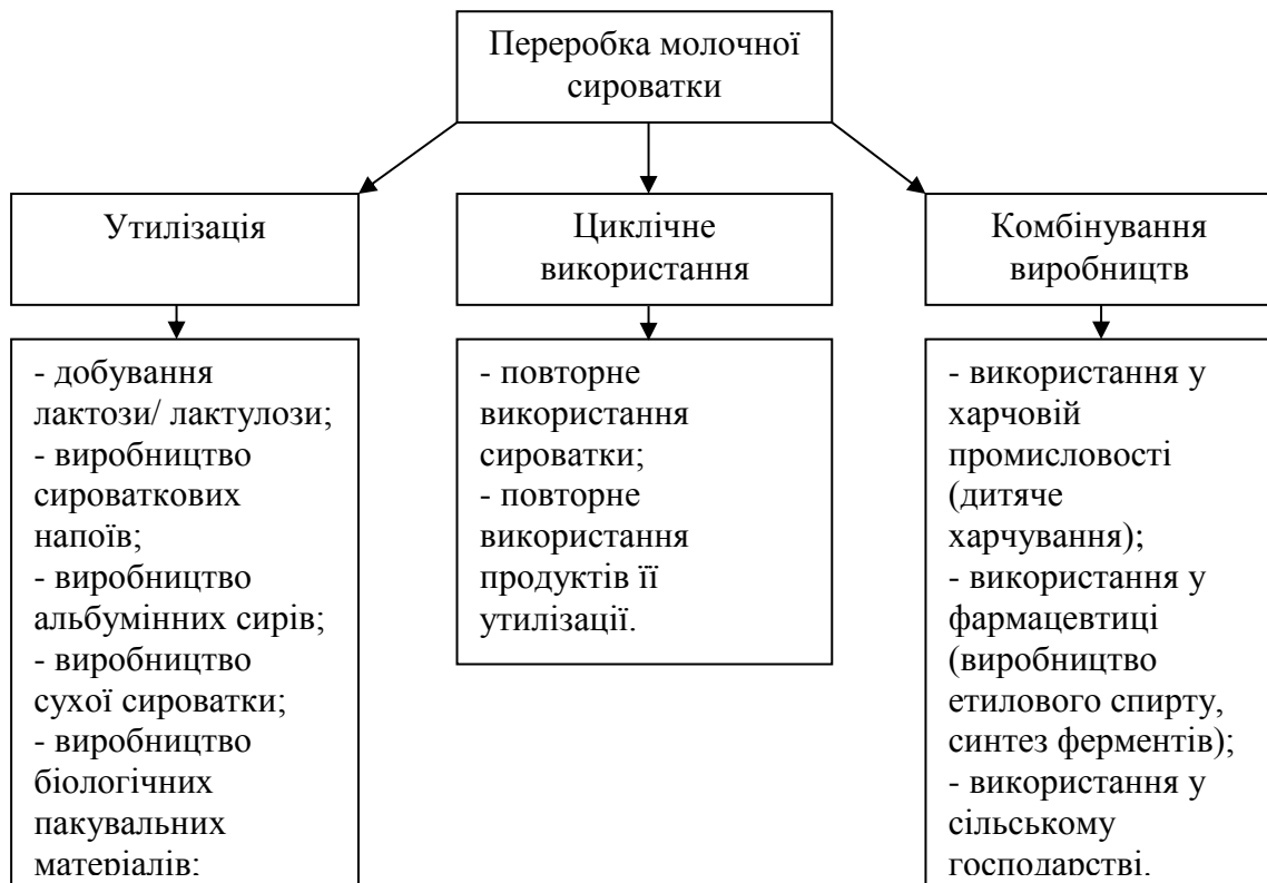
Рис.1. Система переробки молочної сироватки
