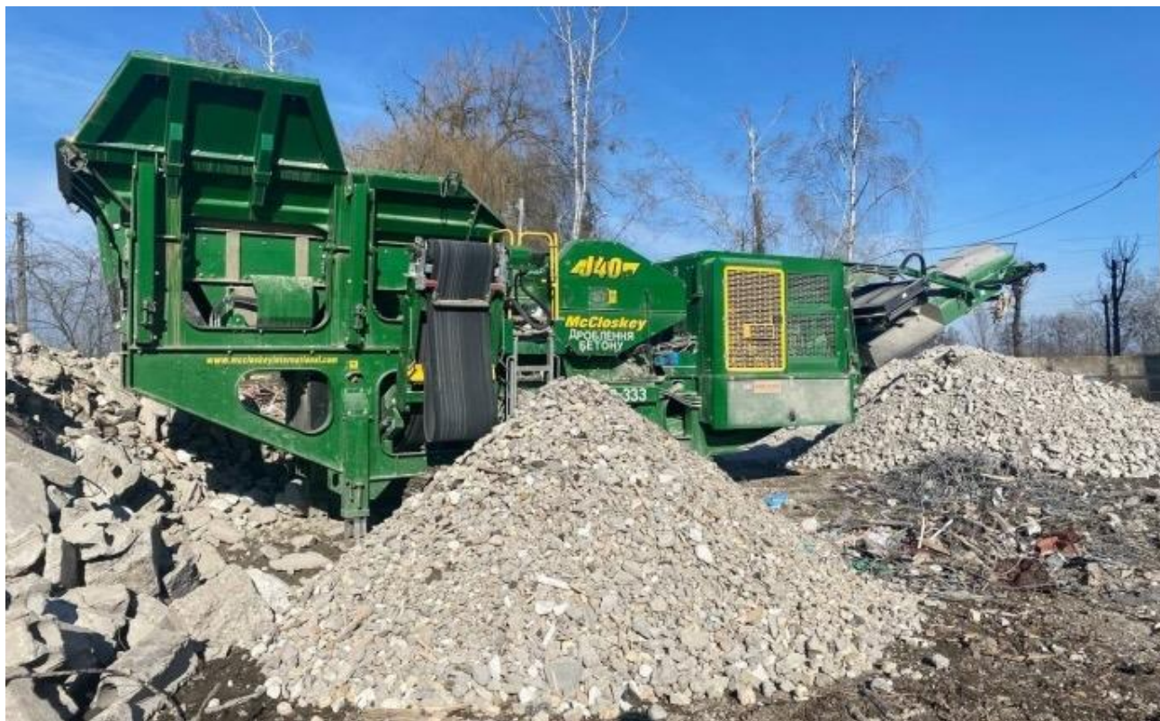
Рис. 4.5. Приклад автоматичного сортування будівельних відходів на окремі фракції (джерело: «НЕО-ЕКО Україна». Режим доступу: https://www.neo-eco.com.ua/ )
