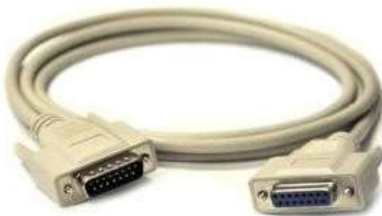
Рисунок 9.13 – Загальний вигляд AUI -кабелю
