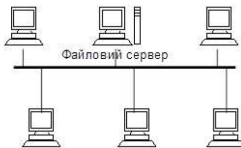
Рисунок 9.20 – Структура шинної топології ЛОМ
