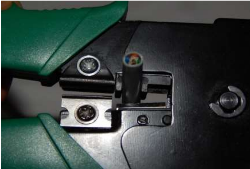
Рисунок 9.24 – Зачистки ізоляції витої пари
