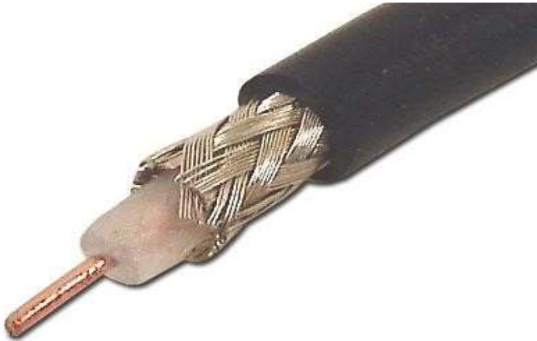
Рисунок 9.7 – Загальний вигляд Cheapernet-кабелю (RG-58, 10Base2)
