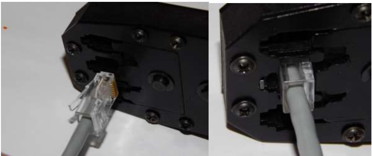
Рисунок 9.29 – Обтискання коннектора з встановленою парою
