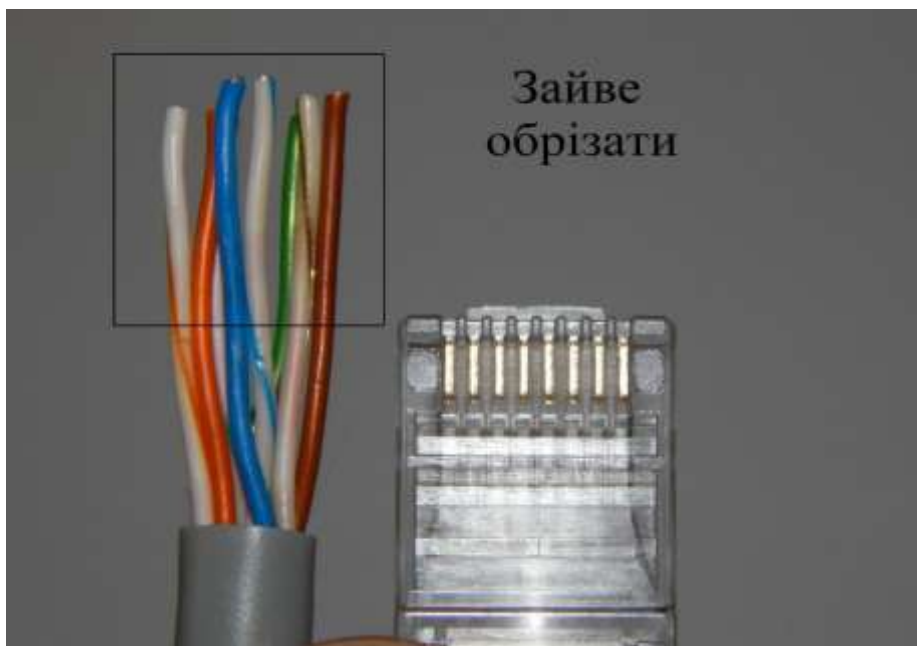
Рисунок 9.27 –Довжина обрізання проводів витвої пари
