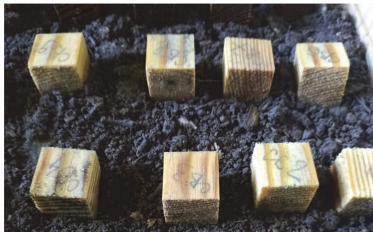
Рис. 9. Поява чорних плям на зразках деревини сосни, обробленої масло-воском, на 24-ту добу
