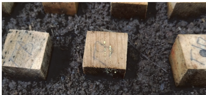
Рис. 10. Зовнішній вигляд зразків необробленого граба на 38-му добу експозиції у агресивних умовах
