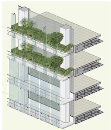
Рис. 8. Конструкція фасадної системи - "жива стіна"
