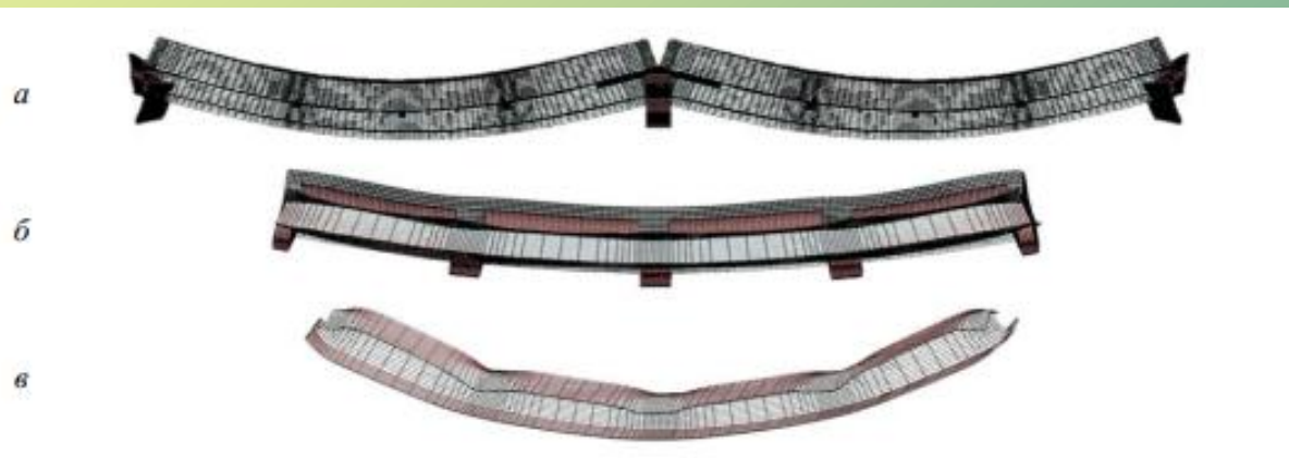
Рис.7. Схема перекриття і балки після розрахунку в ПК «ЛІРА САПР»: a - вид з торця балок; б - вид збоку від балок; в - деформована схема найбільш навантаженої балки
