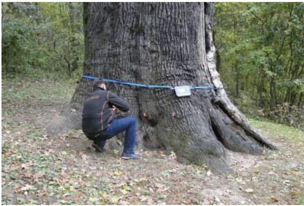
Рис.16-17. Обстеження «Дуба М. Залізняка» сонячним томографом PICUS SONIC
