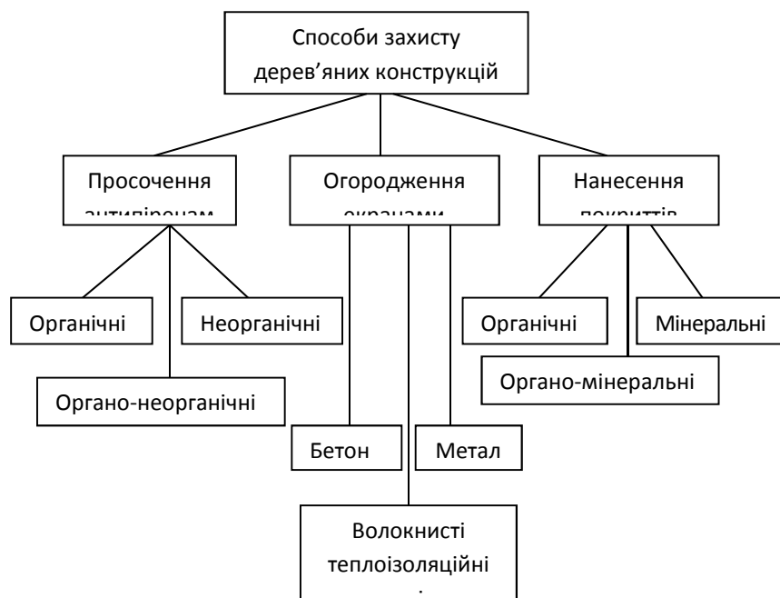
Рис. Способи та засоби вогнезахисту дерев'яних будівельних конструкцій
