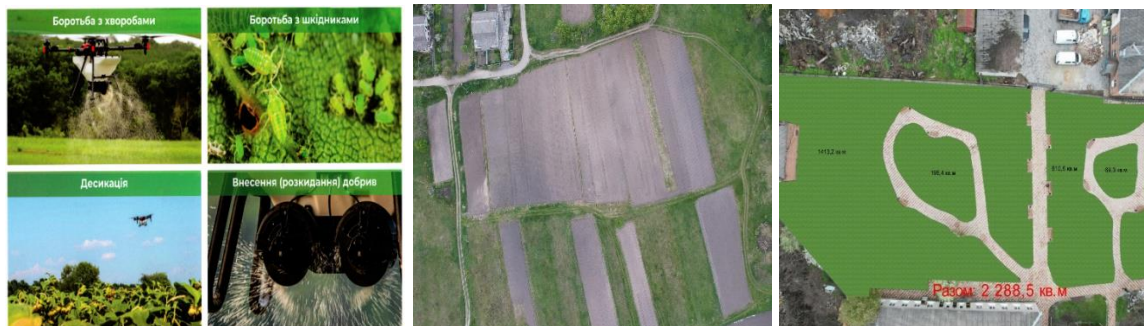
Рисунок 3 – Приклади застосування БПЛА при виконанні с-г робіт та в землеупорядкуванні ( а – хімічний обробіток полів; б – визначення меж ділянок; в – обрахунок площі під посівним газоном). Джерело: результати власних наукових досліджень авторів
