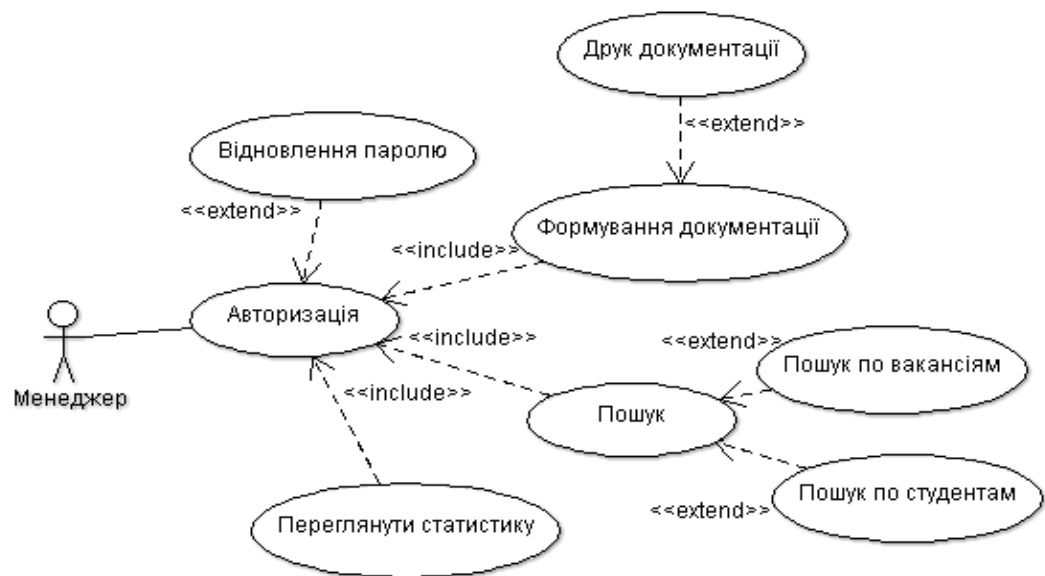
Рис. 4. Use case діаграма для користувача з доступом "Менеджер"
