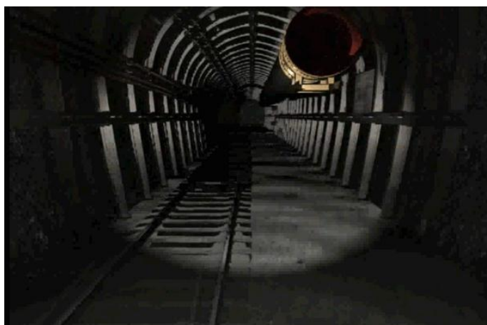
Рис.1. 3D-модель шахтной выработки, проветриваемой вентилятором местного проветривания
