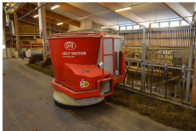
Рис. 11.37. Роботизована роздача кормів в умовах навчальної ферми Norwegian University of Life Sciences
