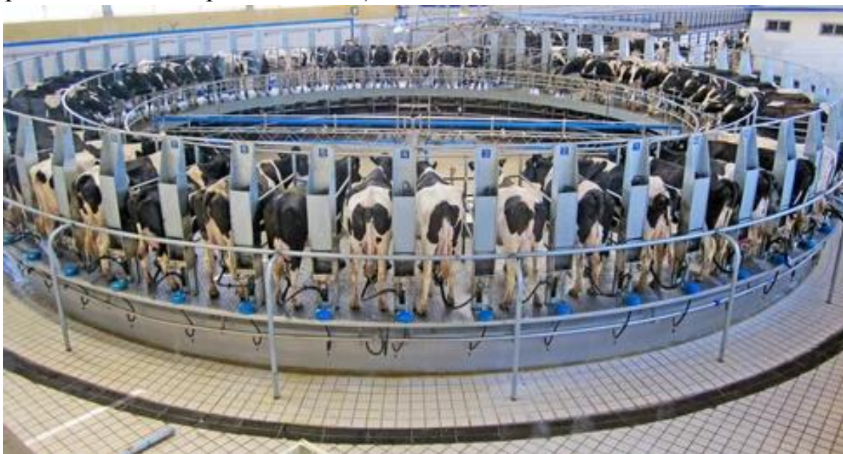
Рис. 1.3.17. Роторна роботизована установка типу – RMS, Канада. http://www.progressivedairycanada.com
