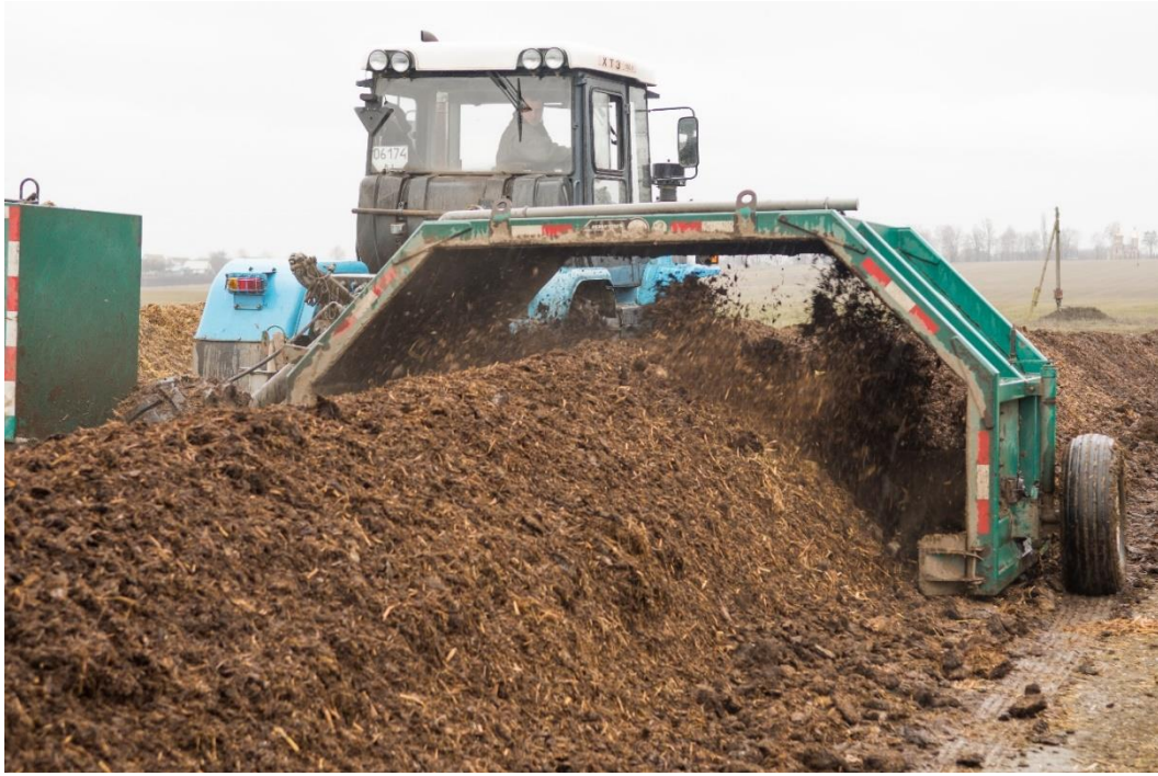
Рис. 4.3. Процес примусової аерації компостних буртів в умовах ТОВ «Агрофірми Колос».
