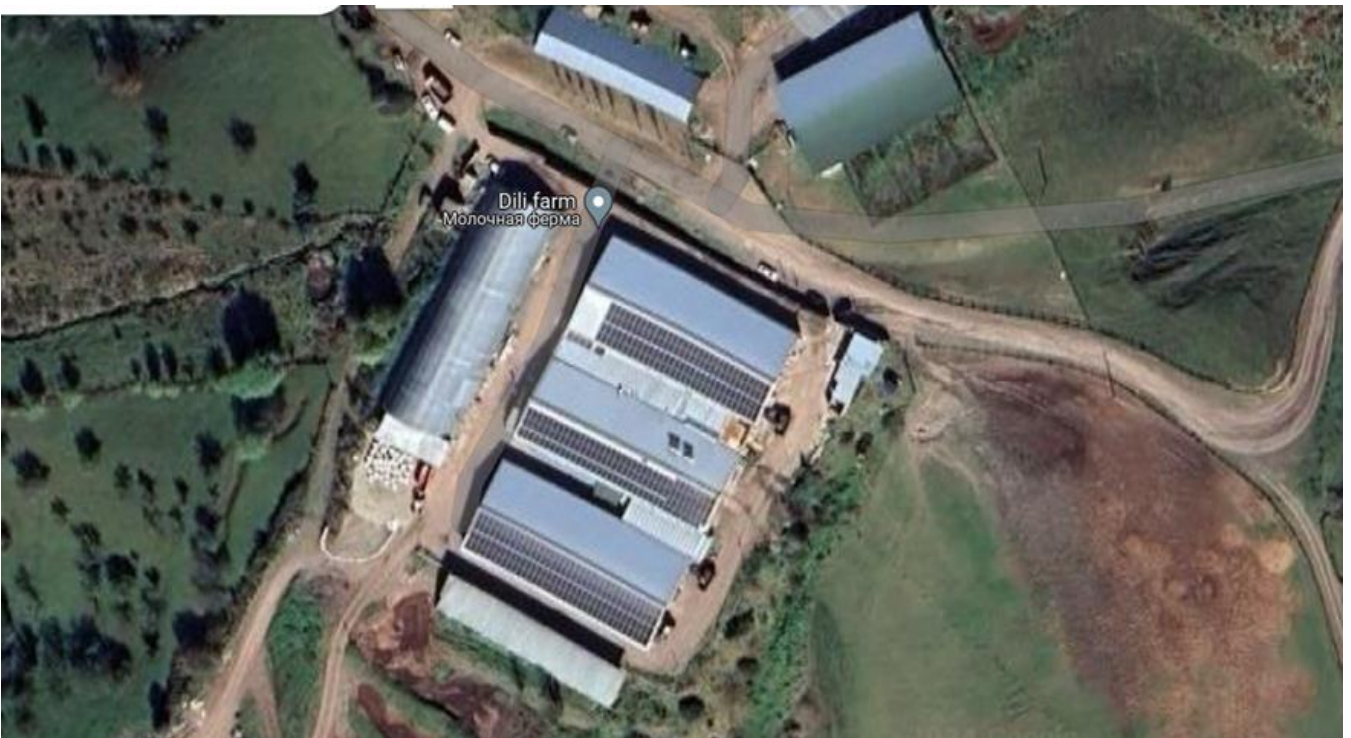
Рис.1.1.2. Сучасне Google фото ферми з виробництва молока „Dili farm”, на південній стороні даху основних виробничих приміщень розміщено декілька рядів елементів сонячних батарей (Вірменія, травень 2024).
