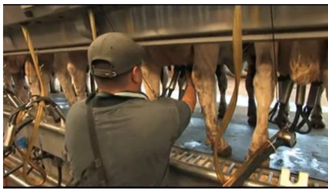
Рис. 13.4. Доїльний зал конфігурації „Паралель” GEA (ліворуч на світліні), з можливостями „швидкого” доїння корів.
