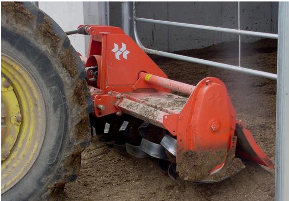
Рис. 1.2.11. Вигляд робочого агрегату (мульчоутворювач) для аерації поверхневого шару підстилки в приміщенні СДВ (Вісконсін США, 2015 рік).
