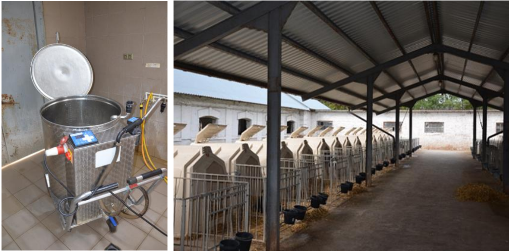
Рис. 13.5. Мобільний автомат – термос для роздавання молока («молочне таксі») для телят віком 0-60 днів (праворуч на світліні) та загальна компоновка будиночків для утримання телят з технологічним навісом над їх передньою частиною (ТДВ „Терезине” Київської обл.).
