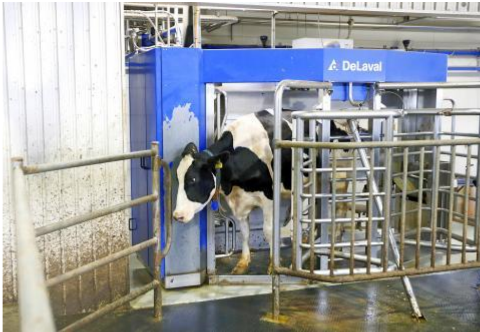
Рис. 1.3.16. Модуль VMS для роботизованого доїння корів компанії DeLaval.
