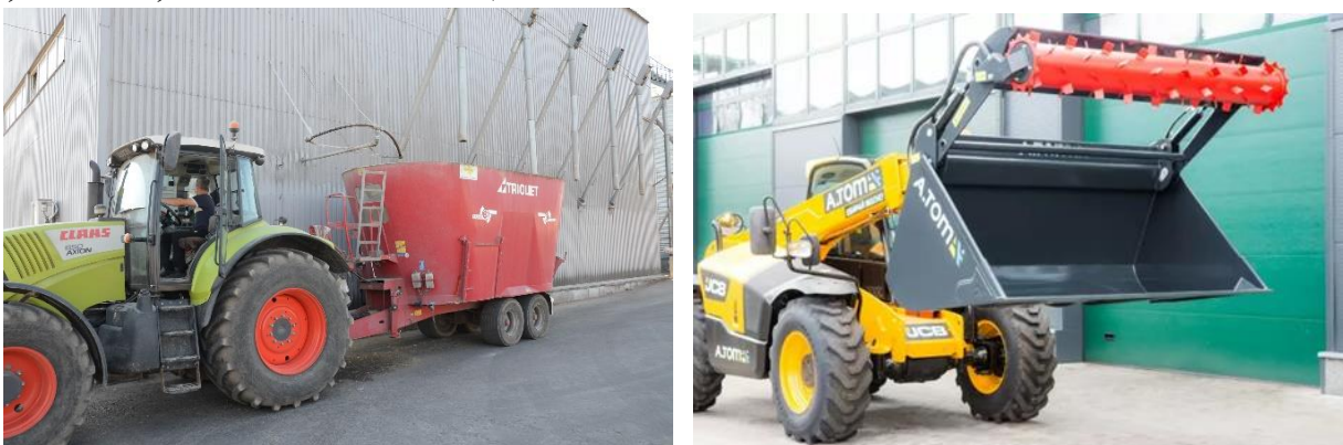
Рис. 13.6. Основна техніка для підготовки та роздавання кормів, ліворуч на світліні мобільний кормозмішувач на 16–18 м 3 з вертикальними шнеками, праворуч телескопічний навантажувач Manitou з ковшем та фрезою для завантаження силосу, сінажу, корнажу на 2,0 м 3 .
