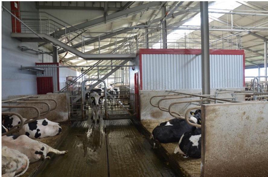
Рис. 1.3.12. Вид модуля (праворуч) роботизованої установки для доїння корів (ПСП „Україна” Попільнянського району Житомирської області).
