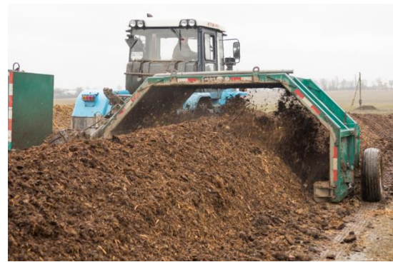
Рис. 13.3. Загальний вид компостних буртів (ліворуч на світліні) та процес їх примусової аерації в умовах ТОВ «Агрофірми Колос» Київської області.
