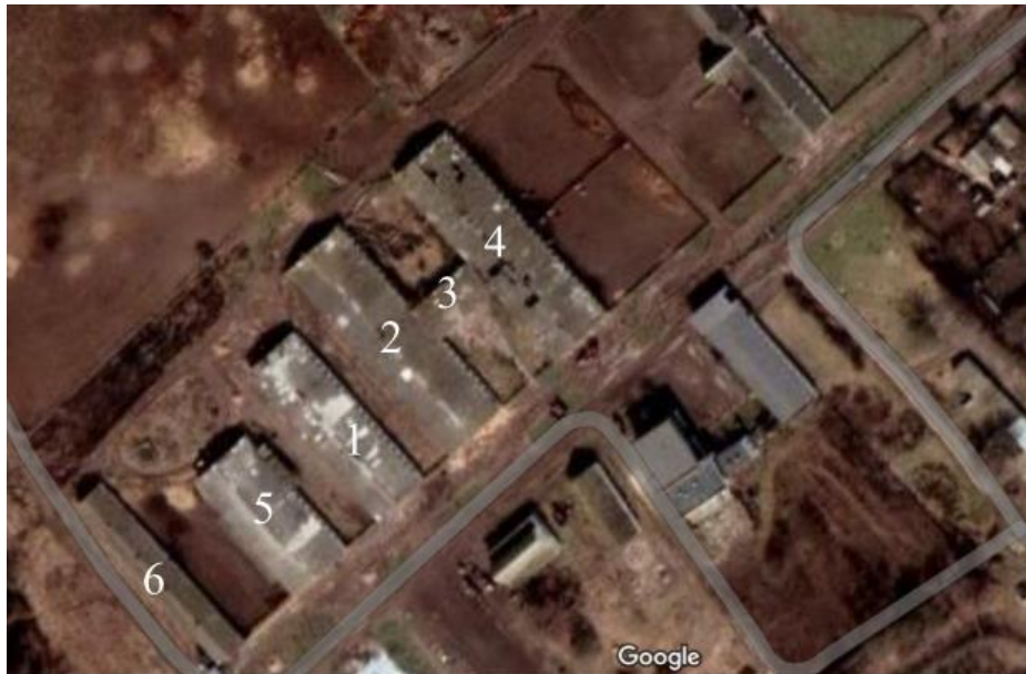
Рис. 3.1.1. План-фото (знімок з Гугл карти ) розміщення виробничих приміщень які підлягають реконструкції (2,4- приміщення опорного типу, 3- модуль для доїльного обладнання між приміщеннями опорного типу), 1- приміщення рамного типу (ключечник), розглядається як можливий варіант для переобладнання в другу чергу.
