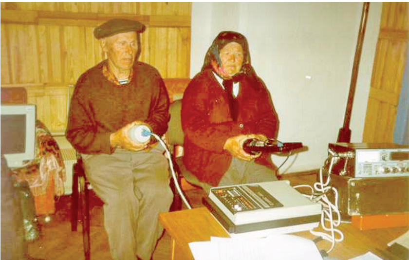
Рис. 6.3. Визначення вмісту ^{137}\text{Cs} в організмі людини (з матеріалів ННЦРМ)
