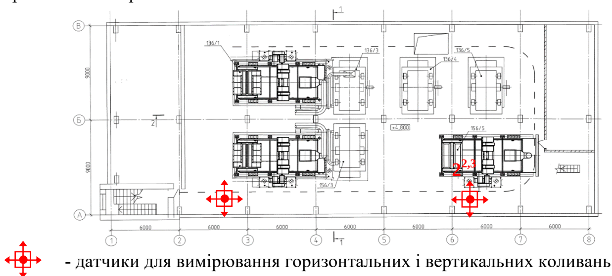
Рис. 3. Розстановка датчиків (акселерометрів) на відм. +4.800 біля грохотів
