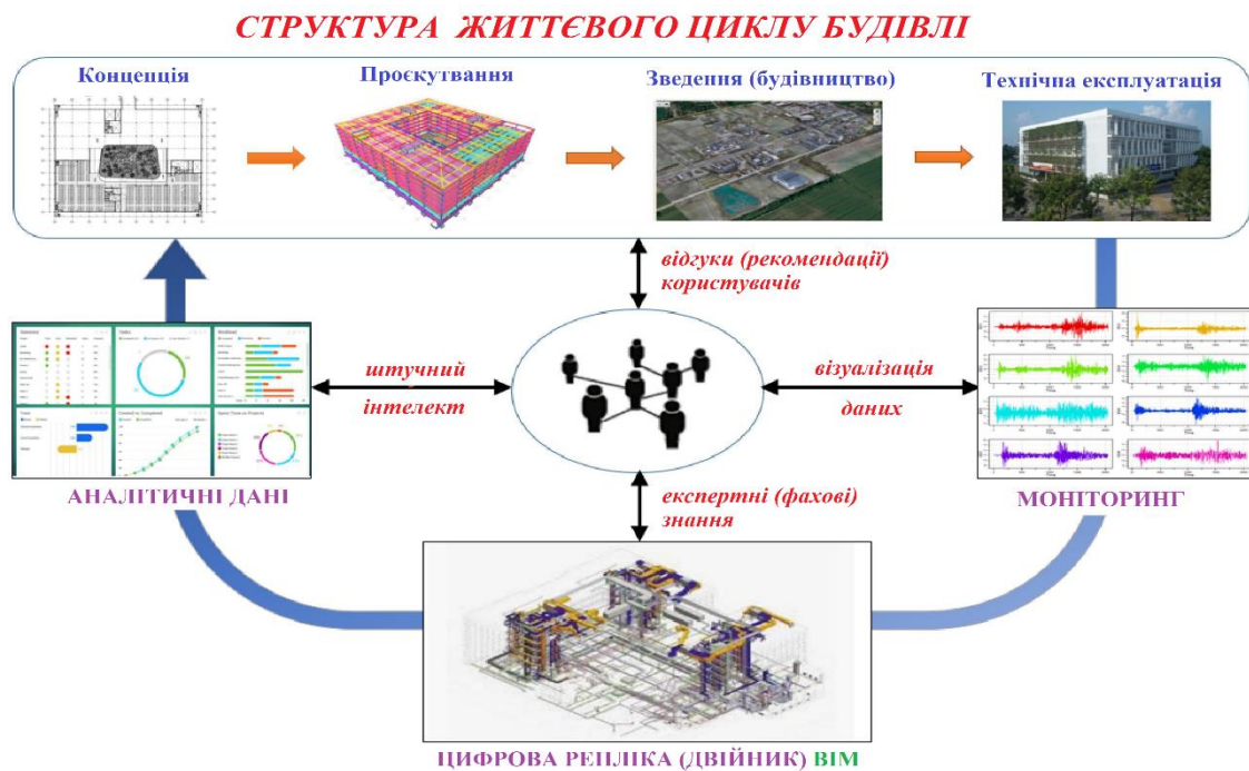
Рисунок 1 – Схема структурна схема життєвого циклу будівлі та/або споруди з використанням DTM
