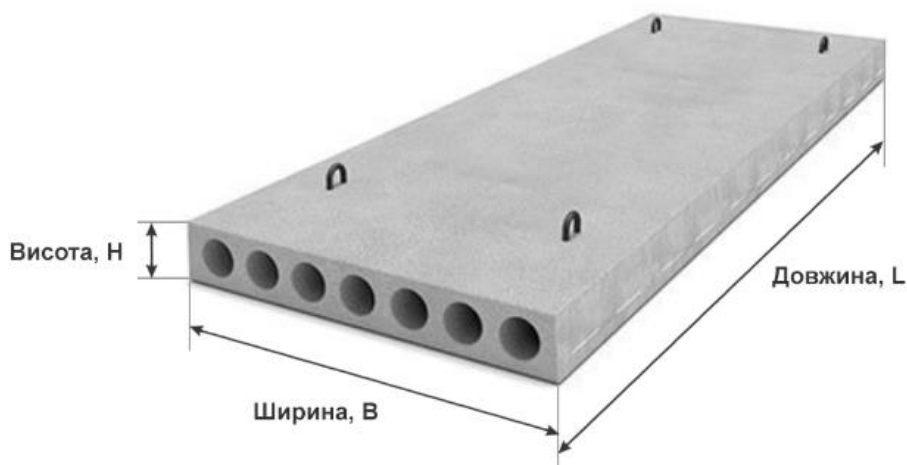
Рисунок 1 – Багатопорожниста плита перекриття із основними габаритними розмірами
