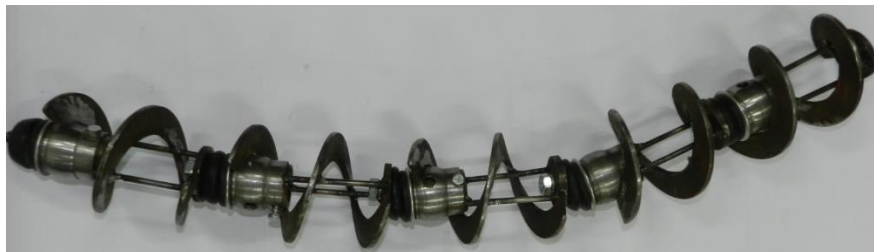
Рисунок 2 – Загальний вигляд робочого органу з шарнірним з'єднанням секцій
