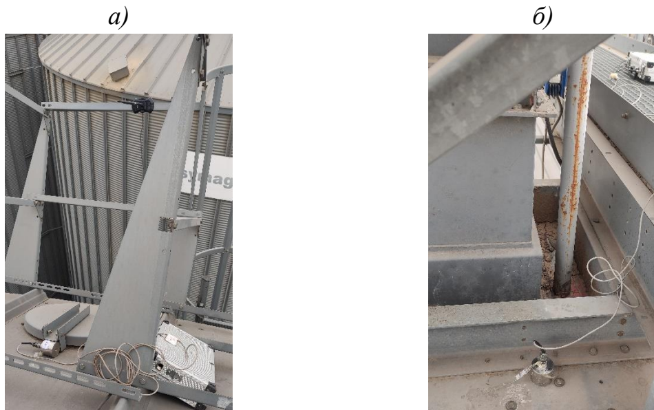
Рисунок 2 – Розміщення датчиків вібрації відповідно до розроблених схем: а – датчик горизонтальних коливань розміщено на позначці +20,000; б – датчик вертикальних коливань розміщено на позначці +27,410 (за схемою 2)
