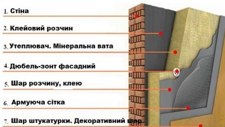
Рис. 1. Приклад утеплення зовнішньої стіни
