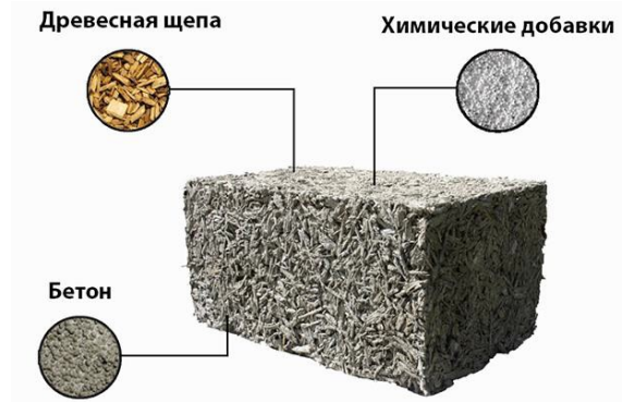
Рис. 1. Арболітовий блок (а) і будова арболіту (б)
