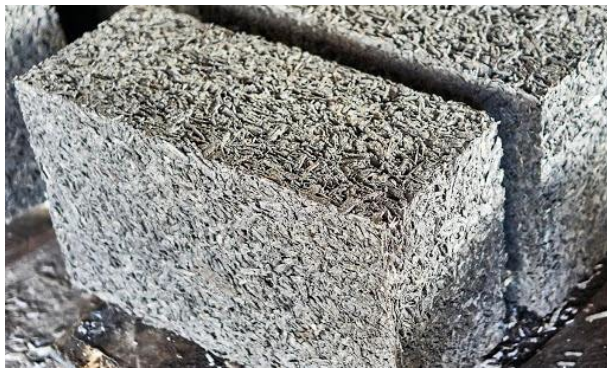
Рис. 1. Арболітовий блок (а) і будова арболіту (б)
