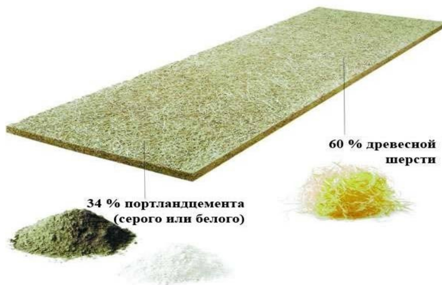
Рис. 1. Склад фібролітової плити
