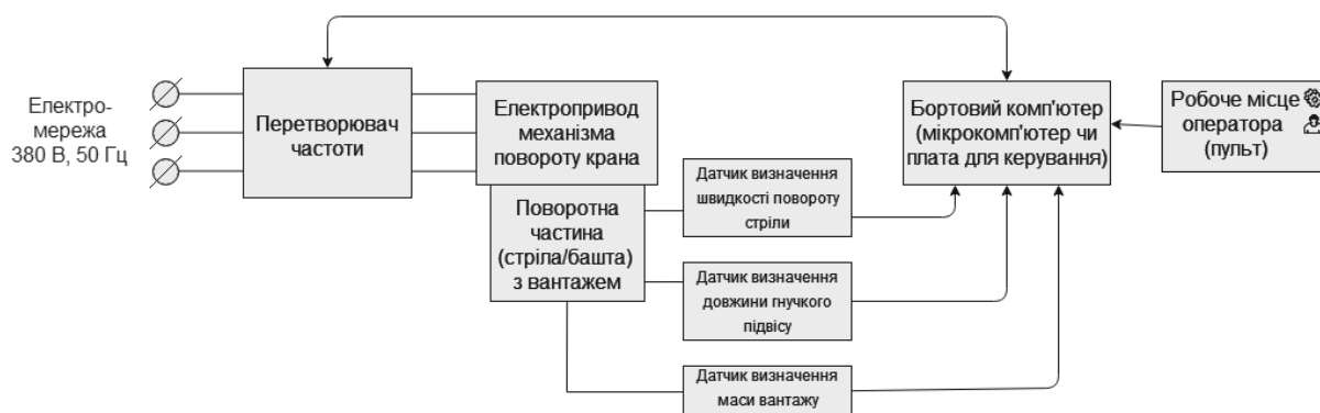
Рис. 5.1. Функціональна схема керування механізмом повороту стрілового крана
