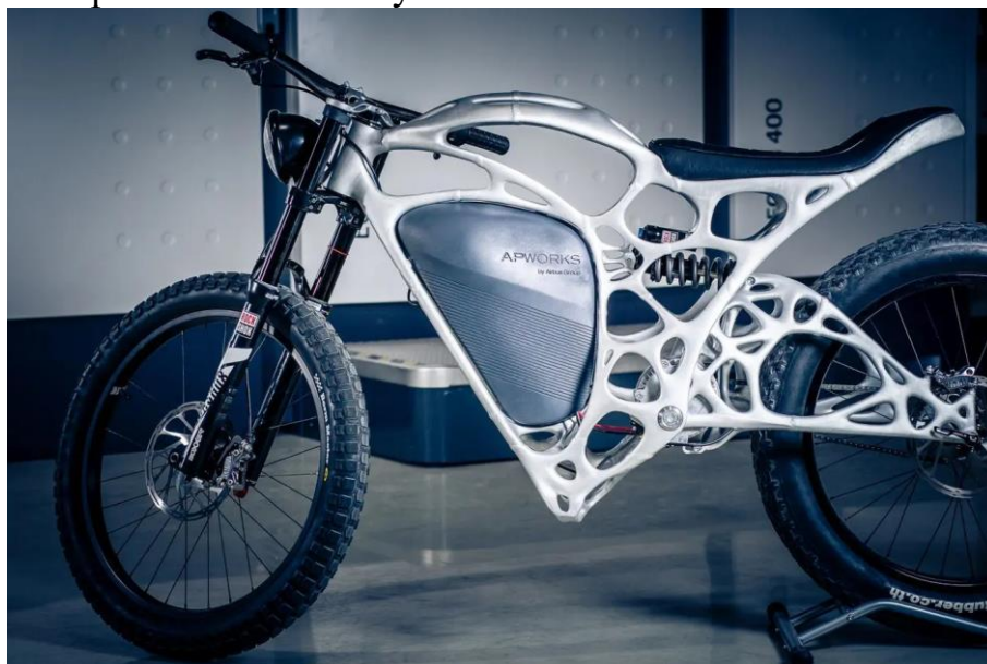
Рис.1. Мотоцикл, створений з генеративним дизайном
