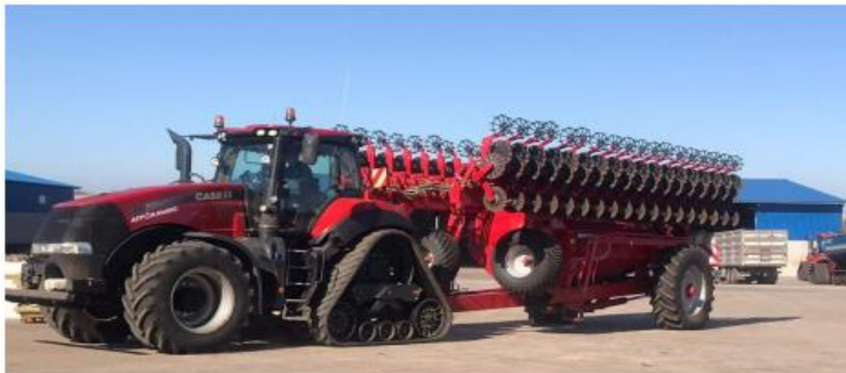
Рис. 1. Агрегат Case MX 380 + Horchsh Maestro 36.5, що використовується в технологіях No-till та Strip-till
