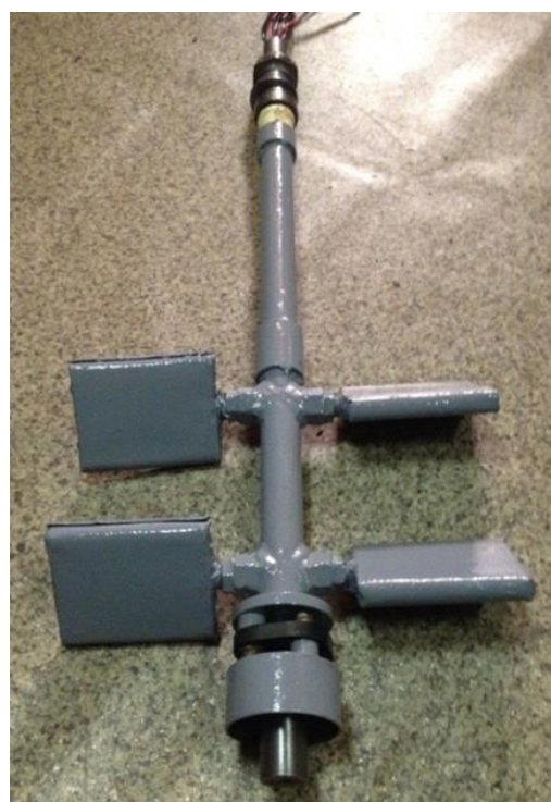
Рис. 1. Комбінованої системи перемішування та підігріву субстрату, а) конструктивна схема: 1 – циліндричний порожнистий вал; 2 – електричний нагрівальний елемент; 3 – лопать; б) вигляд виготовленої комбінованої системи.
