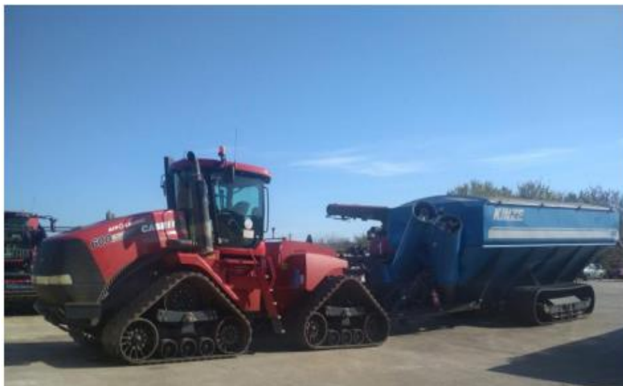
Рис. 3. Агрегат у складі трактора Case IH Quadtrack 600 і бункераперевантажувача Kinze-1350 призначений для збирання зерна від комбайнів, транспортування на край поля і перевантаження в автомобілі
