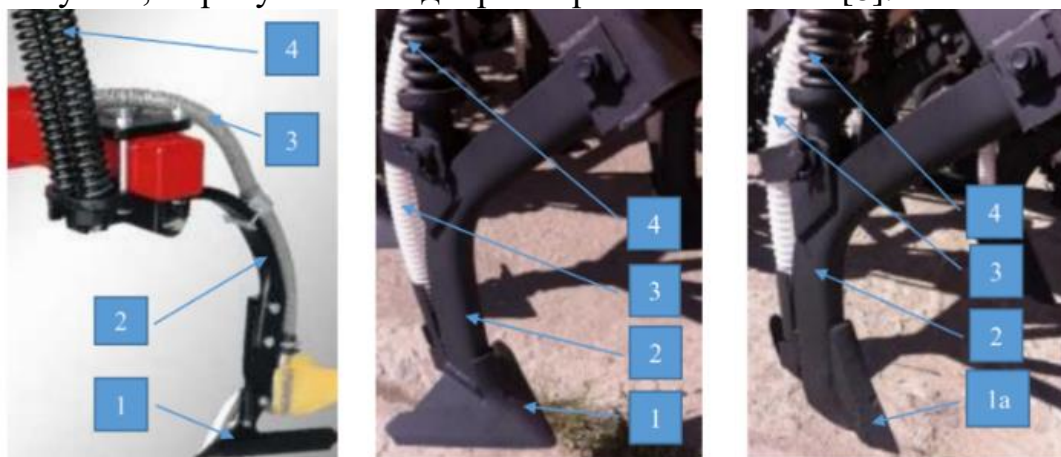
Рис. 3. Анкерні сошники сівалок Horsch Sprinter ST (зліва), Elvorti СЗС-2,1 (по середині-лаповий, справа-долотоподібний) 1-лапа; 1а-долото; 2-стійка; 3-насінепровід; 4-пружинний пристрій
