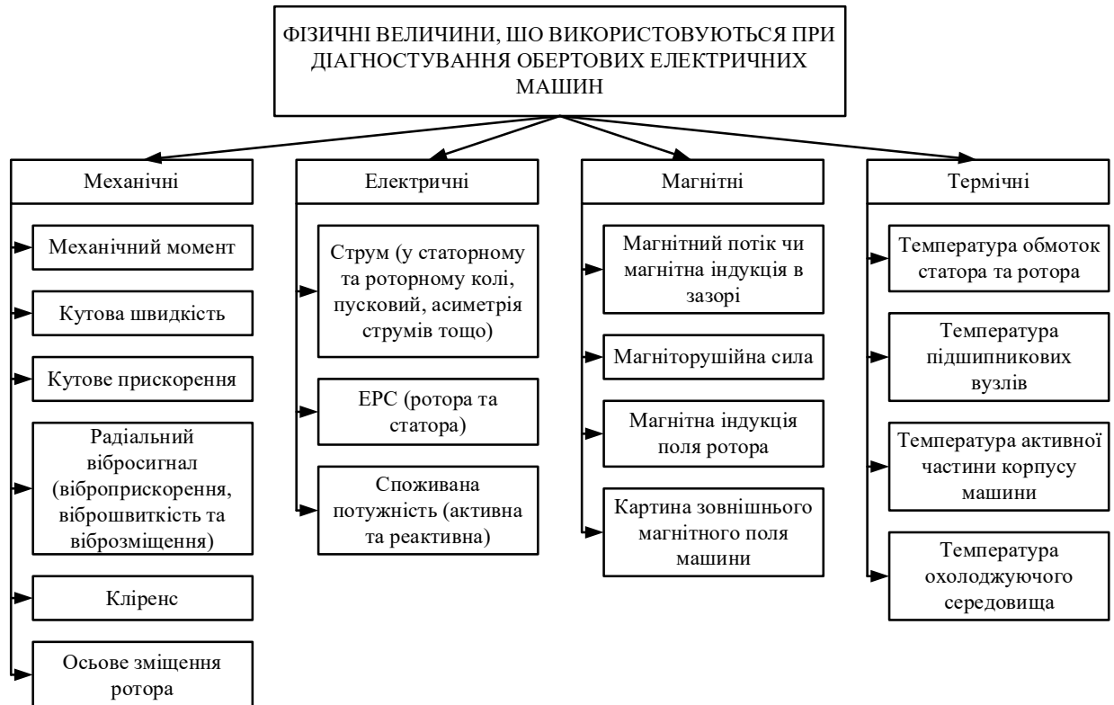
Рис. 1. Фізичні величини, що використовуються при діагностуванні обертових електричних машин
