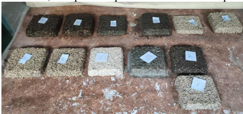
Рис. 1. Перша партія зразків: 1. Деревні частинки + вапно; 2. Деревні частинки + цемент; 3. Деревні частинки + цемент + пісок; 4. Деревні частинки + гіпс + вапно; 5. Деревні частинки + керамзит + вапно; 6. Деревні частинки + керамзит + цемент; 7. Деревні частинки + керамзит + цемент + пісок; 8. Деревні частинки + керамзит + гіпс + вапно
